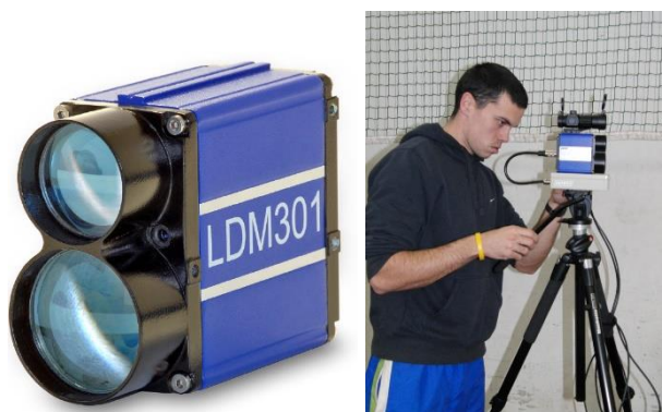
Slika 4. Laserski merilac brzine LDM 301
