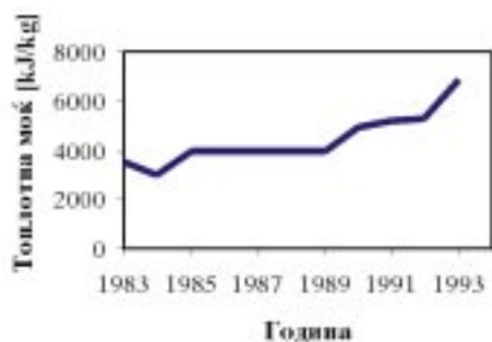
Sl. 2 Promena na topl otnata mo } na CKO vo Kaohsi ung - Tajvan (Liu et al. 1996).
