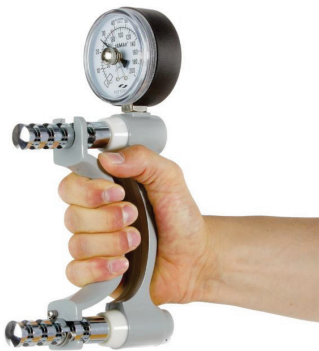
Слика 1. Јатар - аналоген динамометар за проценка на силата на стисок на мускулите флексори на прстите, дланката и подлактицата
