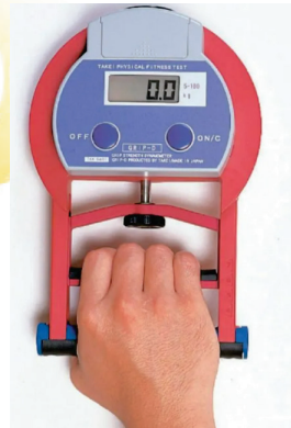
Слика 2. Дигитален динамометар за проценка на силата на стисок на мускулите флексори на прстите, дланката и подлактицата
