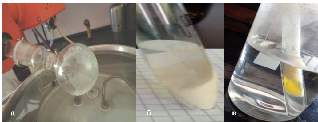
Слика 3.2. Подготовка на мултиламеларни везикули на кетоконазолот со тенок-филмен хидратационен метод: ротоевапоратор (а), липозомска формулација со метанол (б) и липозомска формулација со смеса на сончогледово и маслиново масло, 1:1 \text{ v/v} (в)
