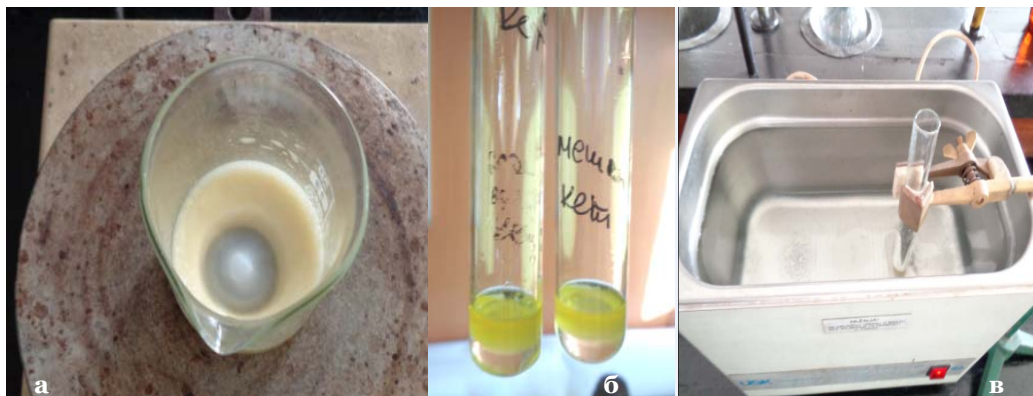
Слика 3.3. Подготовка на мали униламеларни везикули на кетоконазолот: липозомска формулација со метанол (а), липозомска формулација со смеса на сончогледово и маслиново масло, 1:1 v/v (б) и изглед на ултразвучна бања (в)
