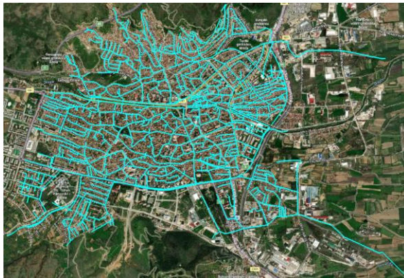
Slika 2. Šematski prikaz modela za analiziranu atmosfersku kanalizaciju Figure 2. Schematic view of the model for the analyzed storm water system
