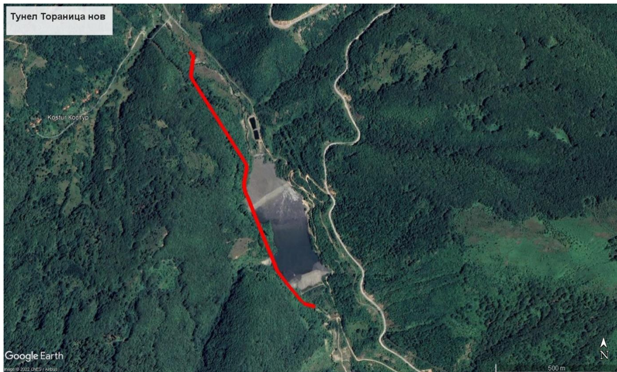
Сл. 1. Локација на хидројаловиште – опточен девијационен тунел
