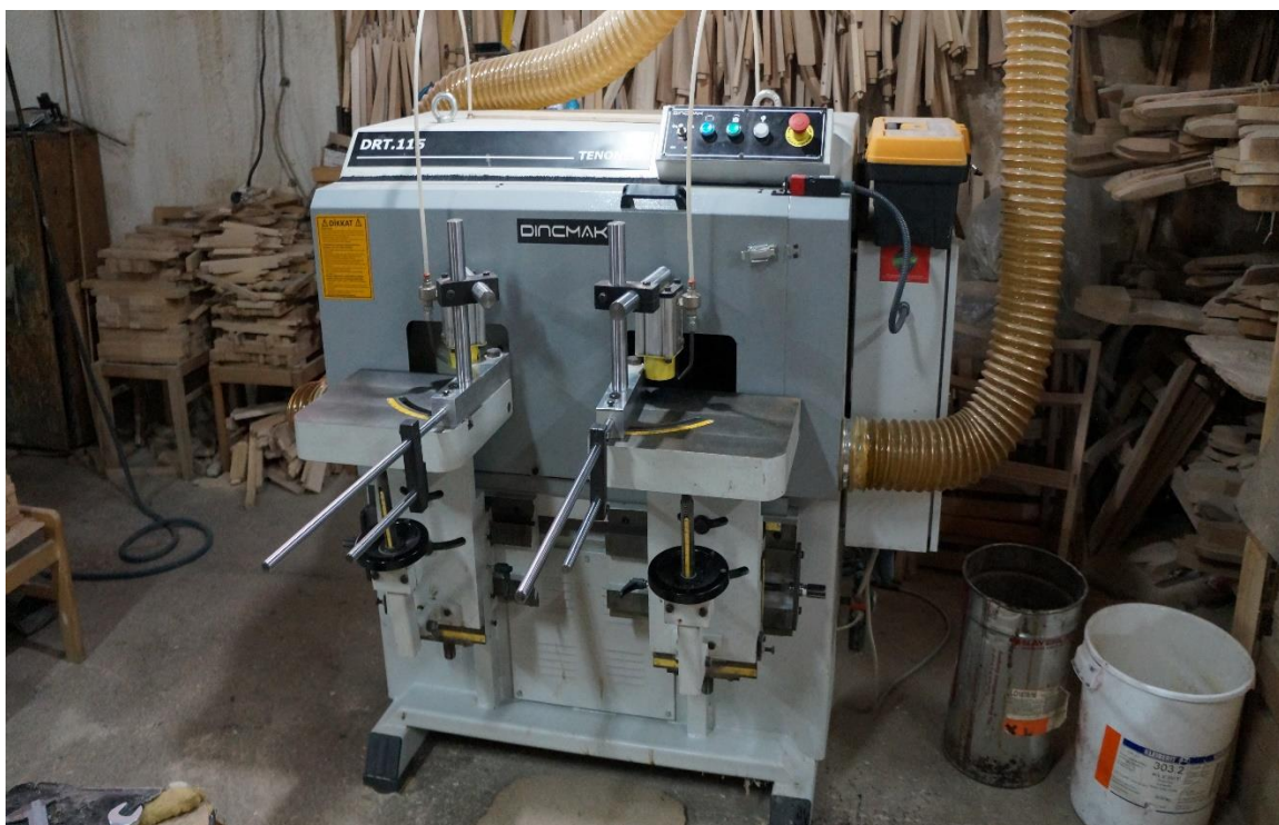
Слика 7: Машина за изработка на чепови “Dincmak DRT115”
