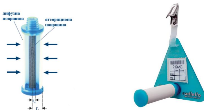
Слика 5. Radiello пасивен семплер (лево: адсорбент од активен јаглен сместен во обвивка од полипропилен со дифузиона дифузија; десно: адсорбентот со обвивка поставен на држач).
