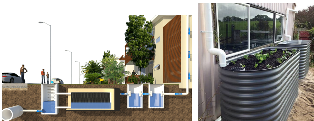
Сл. 3. Примери на изведени ретенциони резервоари за прифаќање на атмосферски води од кровови.
