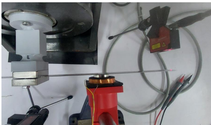
Слика 5.17: Анализа на електромагнетниот претворувач со фиксна намотка
