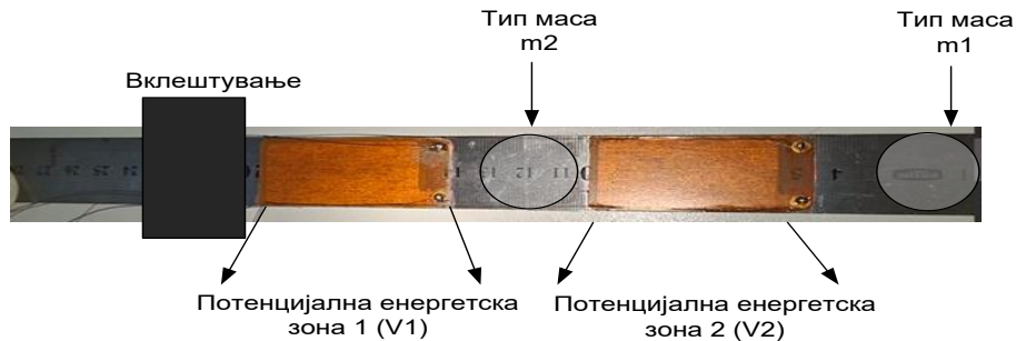
Слика 5.4: Локации на поставување на додадените маси m_1 и m_2 , позициите на интегрираните пиезоелектрични претворувачи и енергетските зони 1 и 2
