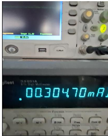
Слика 5.11: Измерен напон од 11.2 V и струја од 0.304 mA на пиезоелектричниот претворувач во енергетска зона 2
