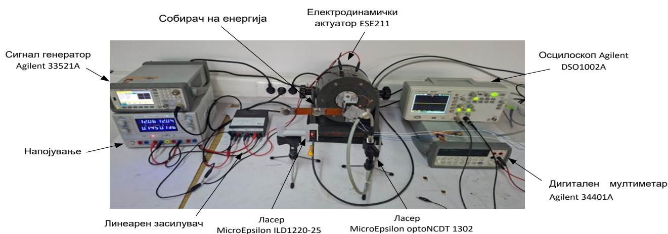
Слика 5.2: Експерименталната поставеност на системот за побуда и собирање на енергија, заедно со мерната опрема користена при експериментите.
