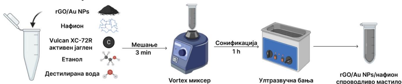
Слика 21. Илустративен приказ на подготовка на мастило базирано на rGO/AuNPs
