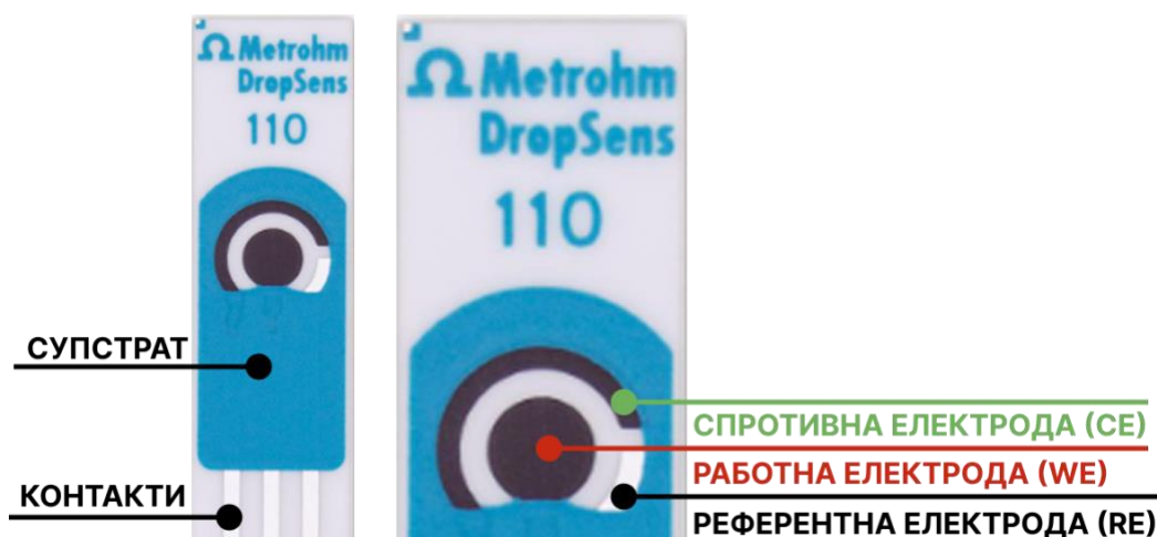
Слика 1. Составни компоненти на триелектродна SPE
