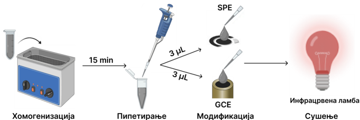
Слика 22. Илустративен приказ на модификација на SPE и GCE со rGO/AuNPs-базирано мастило
