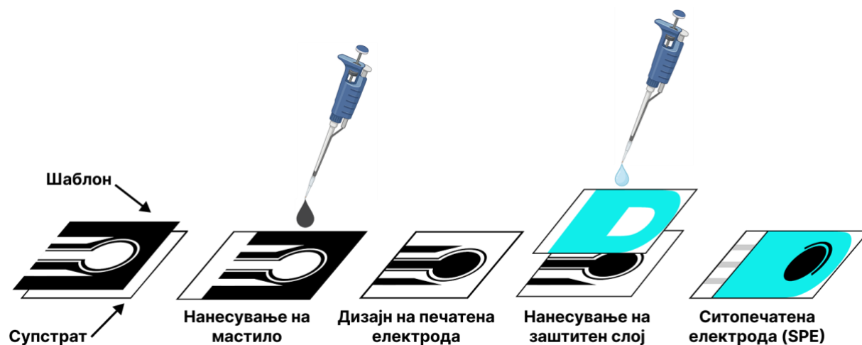
Слика 4. Технологија на печатење електроди со ситопечат.
