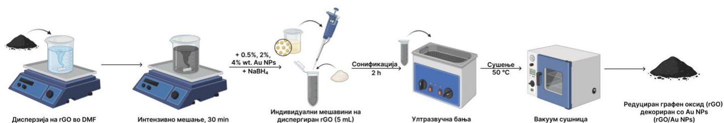
Слика 20. Илустративен приказ на декорација на графен оксид со златни наночестички
