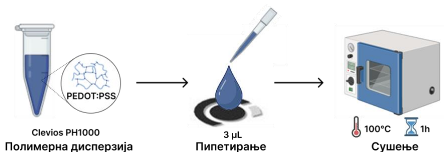
Слика 24. Илустративен приказ на модификација на електроди со PEDOT:PSS преку метод на капка
