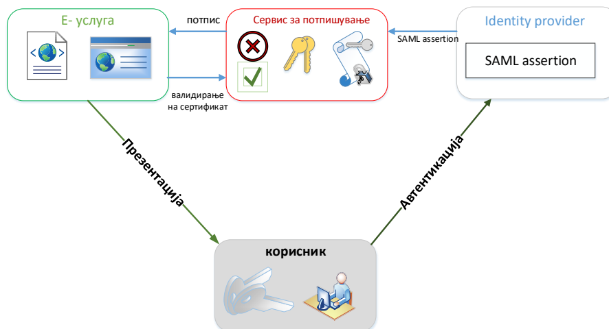
Слика 4: Основна архитектура на процесот на потпишување [95]
