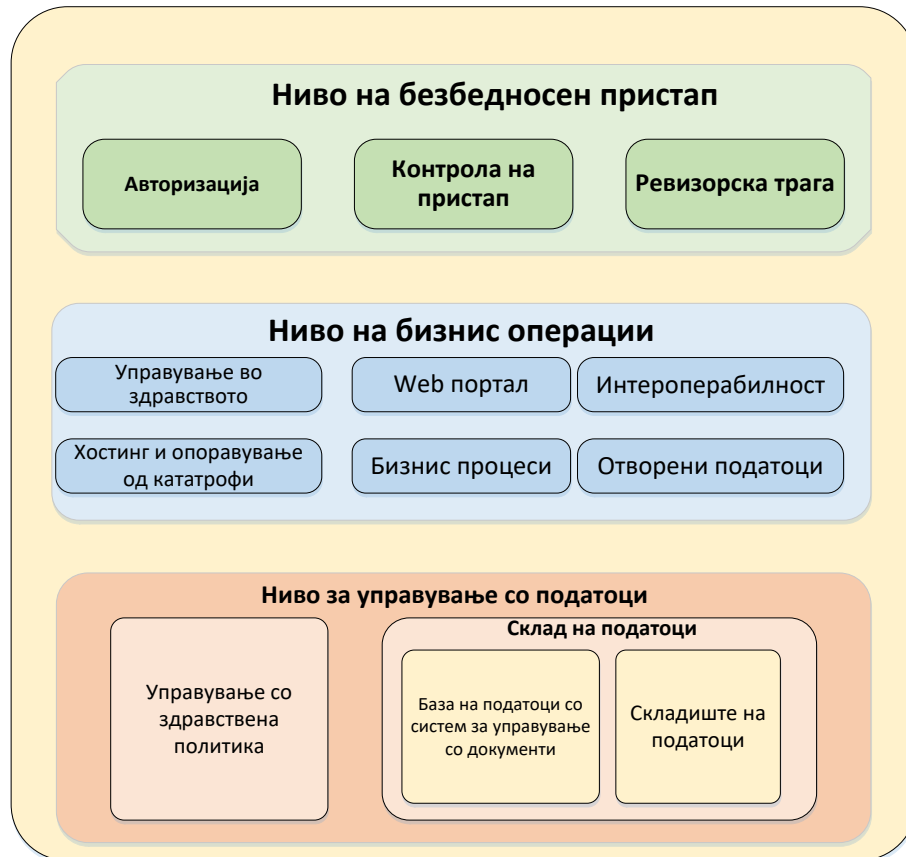
Слика 3: Архитектура на моделот на Електронско здравствено досие
