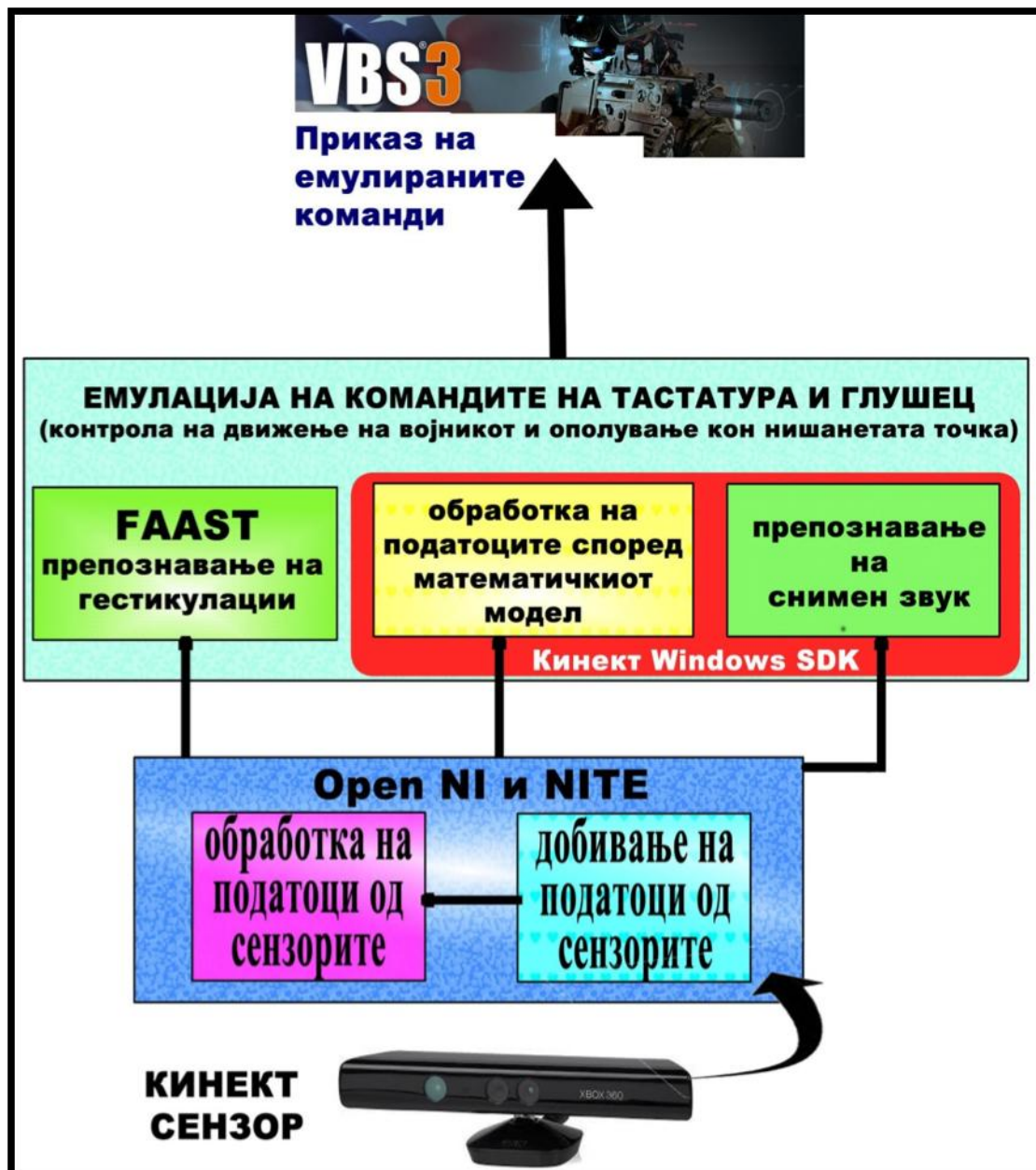
Слика бр. 9. Приказ на искоритените функционалности на Кинект во симулаторот за гагање
