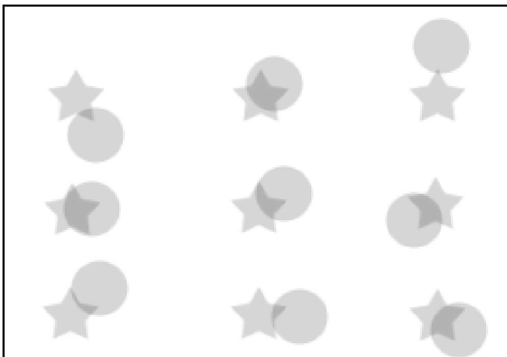
Слика бр. 21. Илустрација на нелинеарноста помеѓу калибрациските точки и добиените вредности од Кинект сензорот
