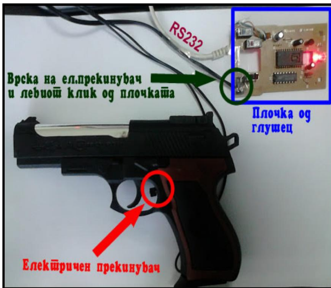
Слика бр. 15. Решение за кликање (окинување) на оружјето со помош на електричен прекинувач-тест приод
