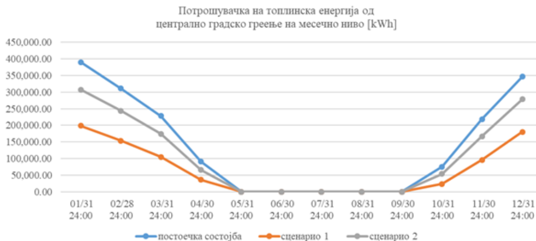
Сл. 9. Компарација на потрошувачката на топлинска енергија за греење на месечно ниво
