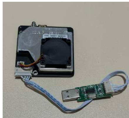
Fig. 4 Nova SDS011 AQI sensor
