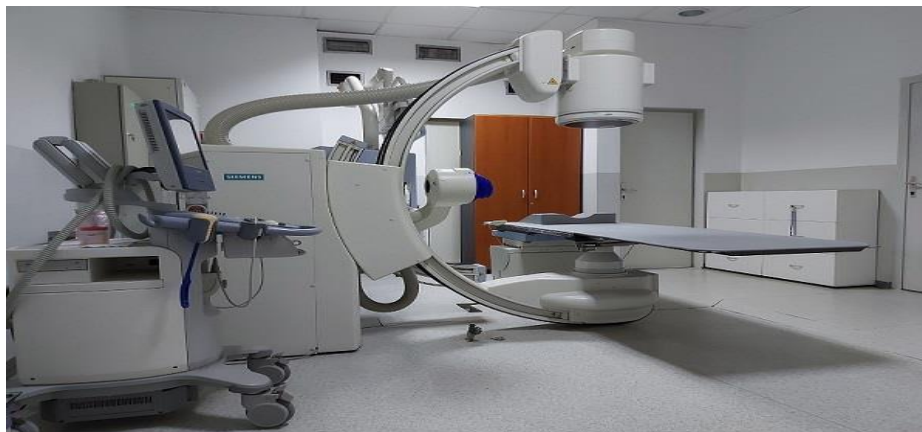
Слика 13 Екстракорпорален литотриптор од третата генерација на електромагнетни литотриптори (Lithoskop®, Siemens Medical Systems, Erlangen, Germany)
