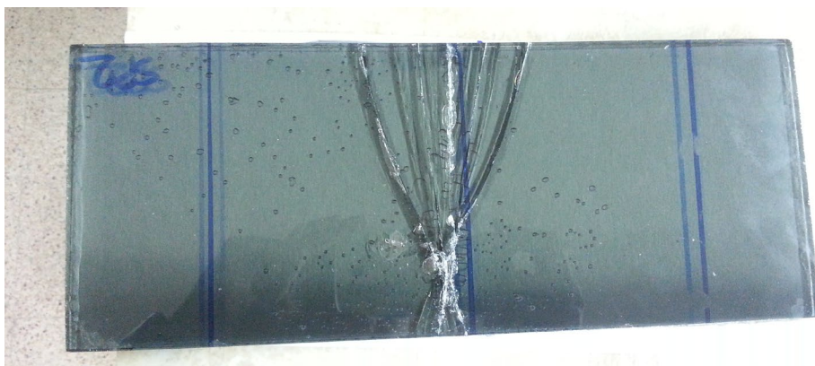
Слика.6.6 Моделот со употребено лепило DC3140 по испитувањето
