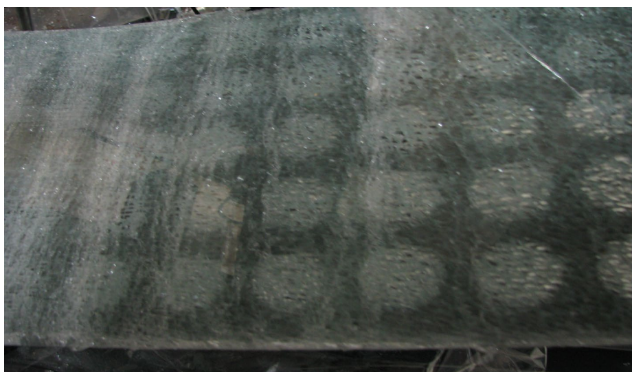
Слика 6.11: Изглед на шемата на кршење специфичен за испитување со потпирање во четири точки
