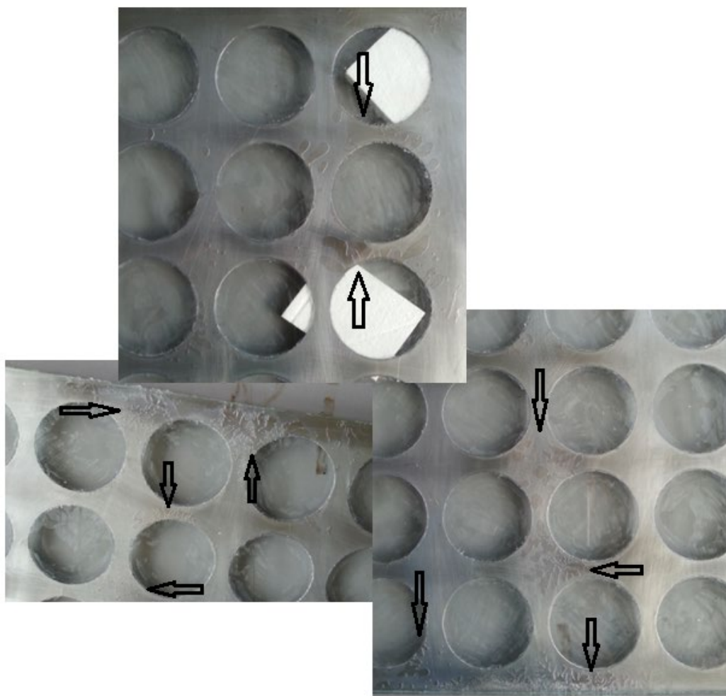
Слика 7.50: Грешки во слојот од лепило кај хибридните модели BSG.60_8
