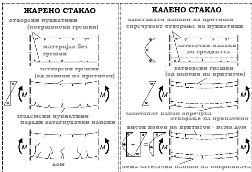
Слика 2.9: Напонска состојба на термички обработено стакло
