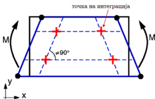
Слика 5.10: Ефект на Shear locking
