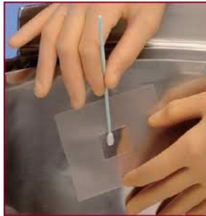
Слика 41. Земање брис од млекарски сад
