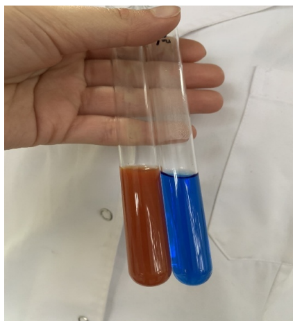
Слика 30. Реакција за определување лактоза: лево – позитивна Фелингова реакција (формирање црвен талог на \text{Cu}_2\text{O} ), десно – негативна Фелингова реакција (син раствор на \text{Cu}^{2+} јони)
