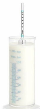
Слика 8. Одредување густина на млекото со лактодензиметар
