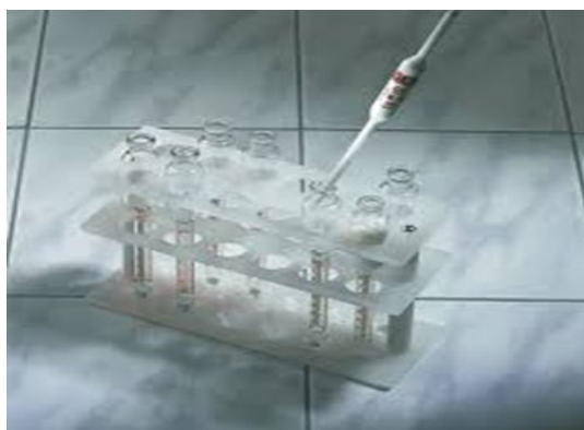
Слика 19. Додавање млеко во бутирометарот
