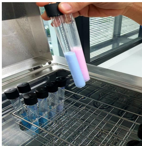
Слика 53. Приказ на редукција на резазурин
