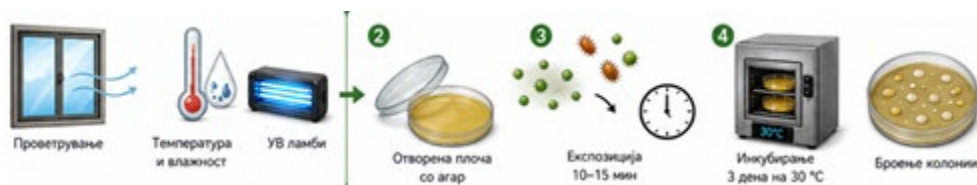
Слика 39. Испитување микробиолошка контаминација на воздухот
