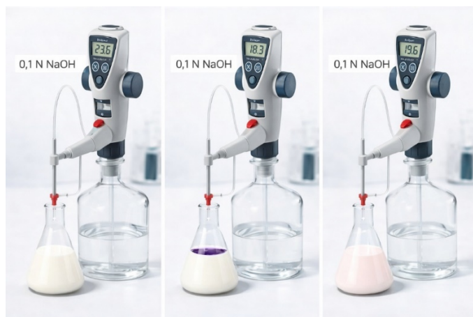
Слика 12. Одредување степен на киселост (лево – пред титрација, средина – во тек на титрација, десно – по титрација)
