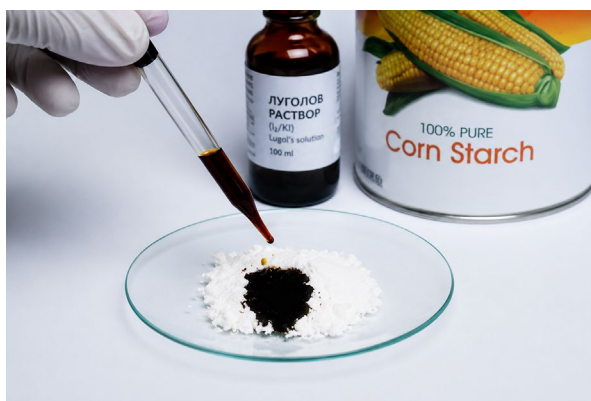
Слика 59. Реакција на брашно со Луголов раствор
