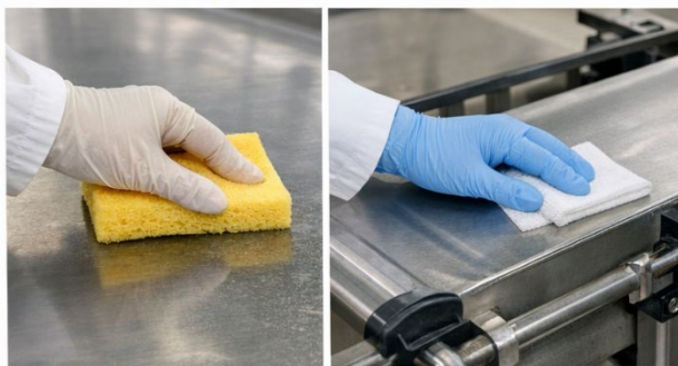
Слика 42. Метод на земање брисови со сунѓери и газы
