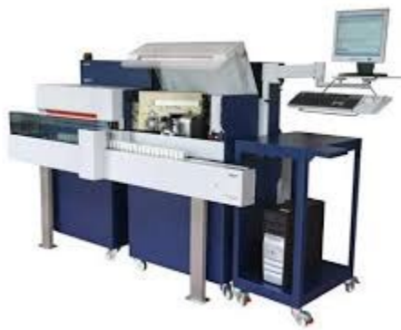
Слика 34. Апарат Fossomatic за автоматско определување на соматски клетки
