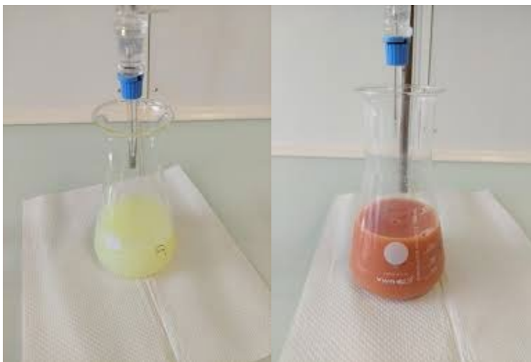
Слика 57. Изглед пред титрација со сребро нитрат и по титрација со сребро нитрат
