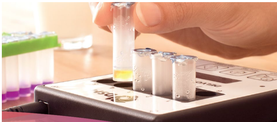
Слика 46. Негативен Delvotest после инкубација
