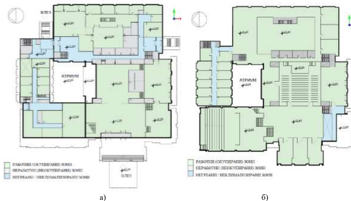
Сл. 2. Поделба на термални зони (зонирање) а) основа на приземје; б) основа на кат
