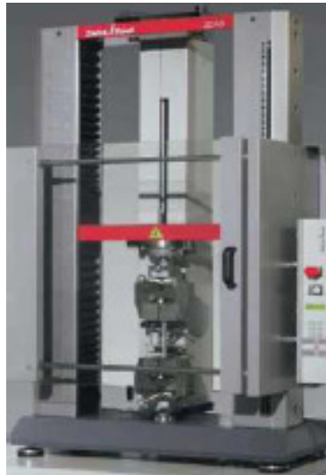
Слика 4. 13. Инструмент за механички испитувања при истегнување
