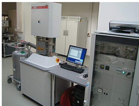
Слика 4. 16. Инструмент за динамо–механичка термичка анализа ( Eplexor-2000N)
