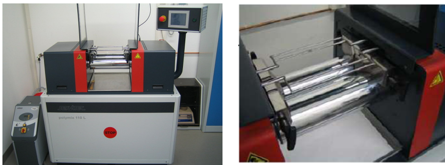
Слика 4.5. Лабораторски двовалјак Polymix 110L, со големина 203 x 102 mm, произведен од Servitex GmbH, Германија
