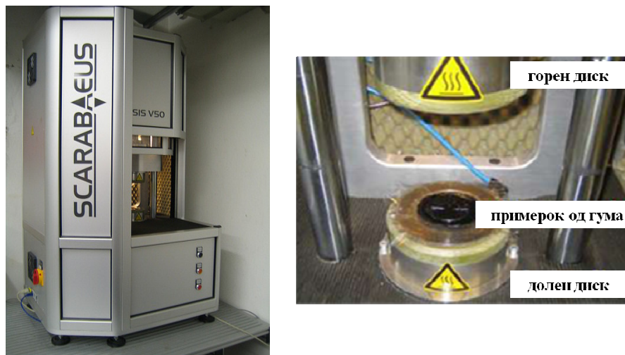
Слика 4. 18. Реометар Scarabaeus SIS-V50
