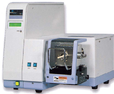
Слика 4. 7. Perkin Elmer Pyris Diamond термогравиметар
