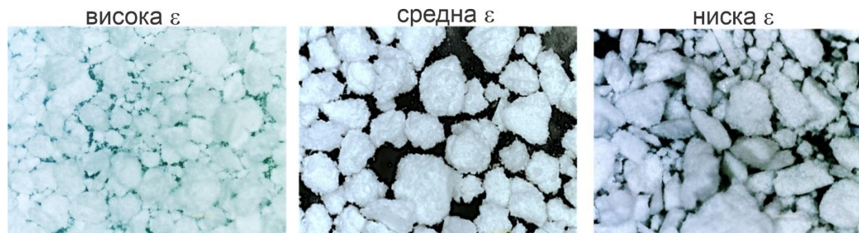
Слика 7: Гранули коишто се произведени од компактирани ленти со висока, средна и со ниска \epsilon , визуализирани под оптички микроскоп.
