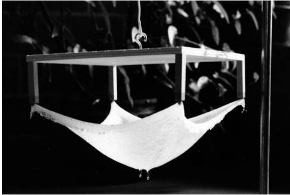
Сл. 3 Дигитална репродукција добиена со динамичка релаксација на физички модел на Хајнц Ислер
