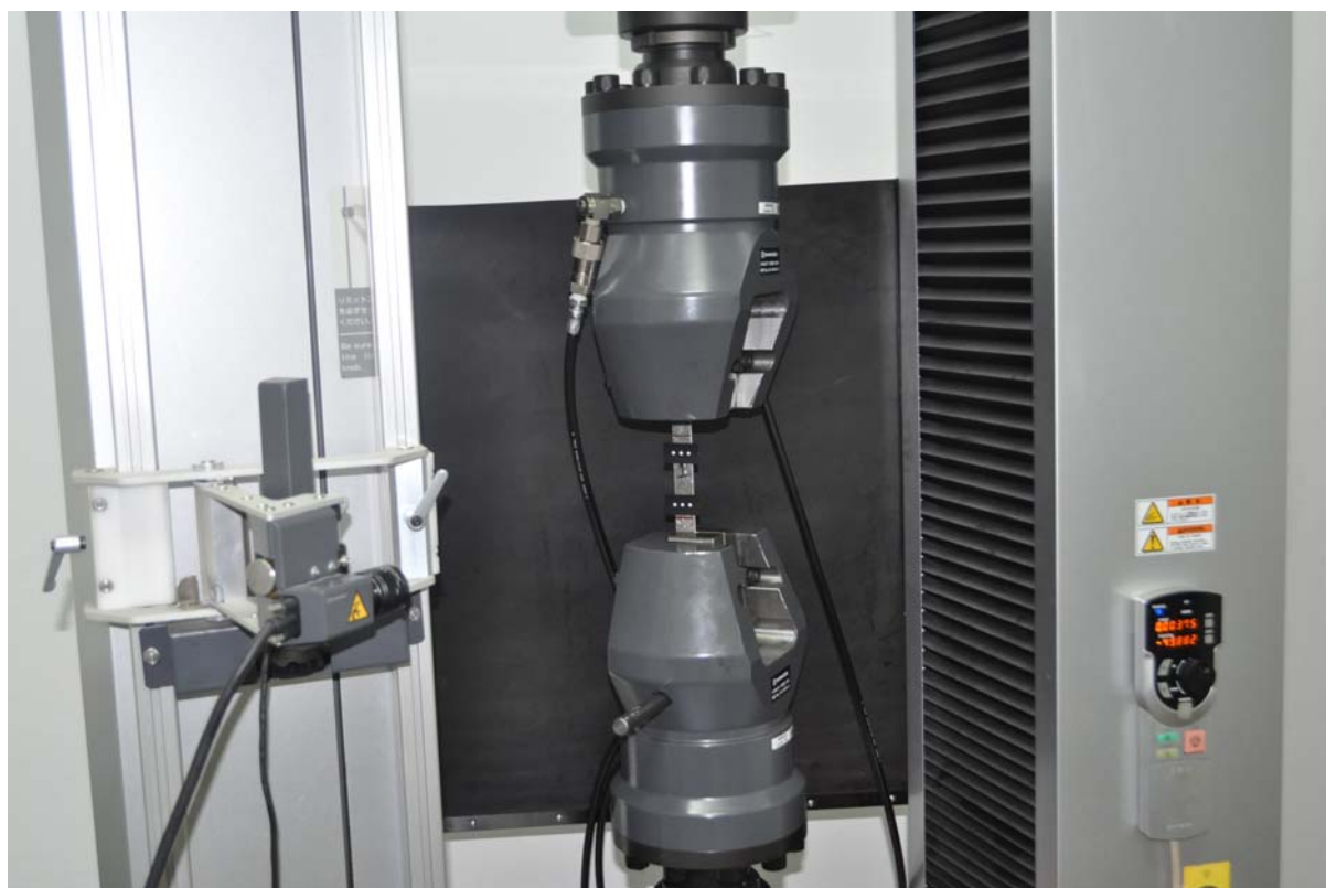
Слика 92. Испитување на механичките карактеристики на материјалот на одбојниците
