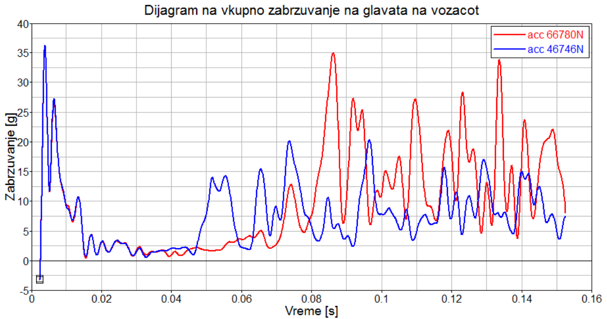
Слика 153. Вкупно забрзување на главата на возачот за различно притегање на навојните врски на одбојниците
