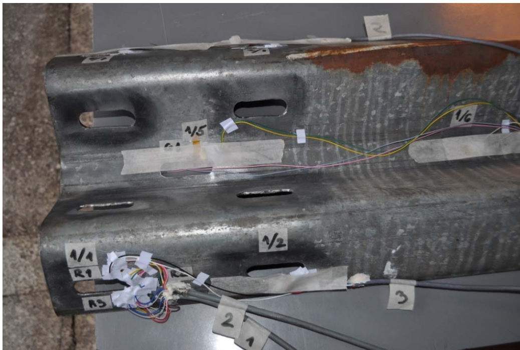
Слика 89. Позиција на поставување на мерни ленти на горниот одбојник
