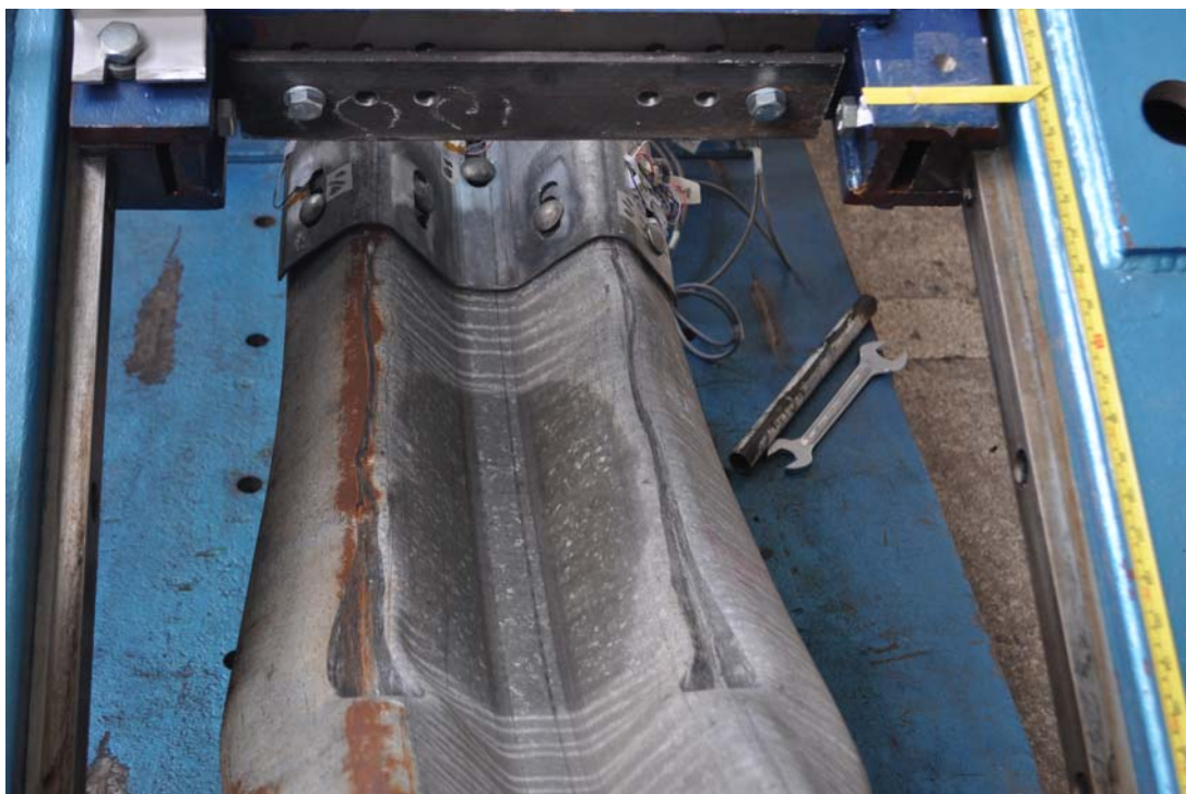
Слика 133. Состојба на место на ударот на хидрауличниот цилиндар при реалниот експеримент
