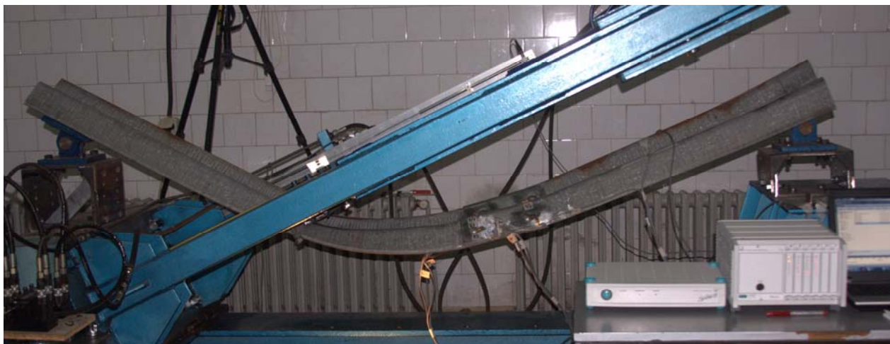
Слика 131. Чекори на оптоварување на хидрауличниот цилиндар и крајната положба на одбојникот при реалниот експеримент
