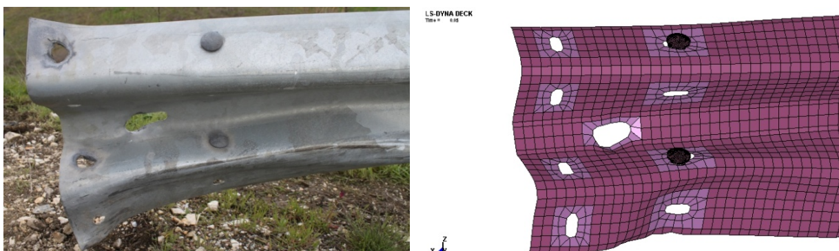
Слика 157. Реална ситуација и МКЕ модел на начинот на деформација
