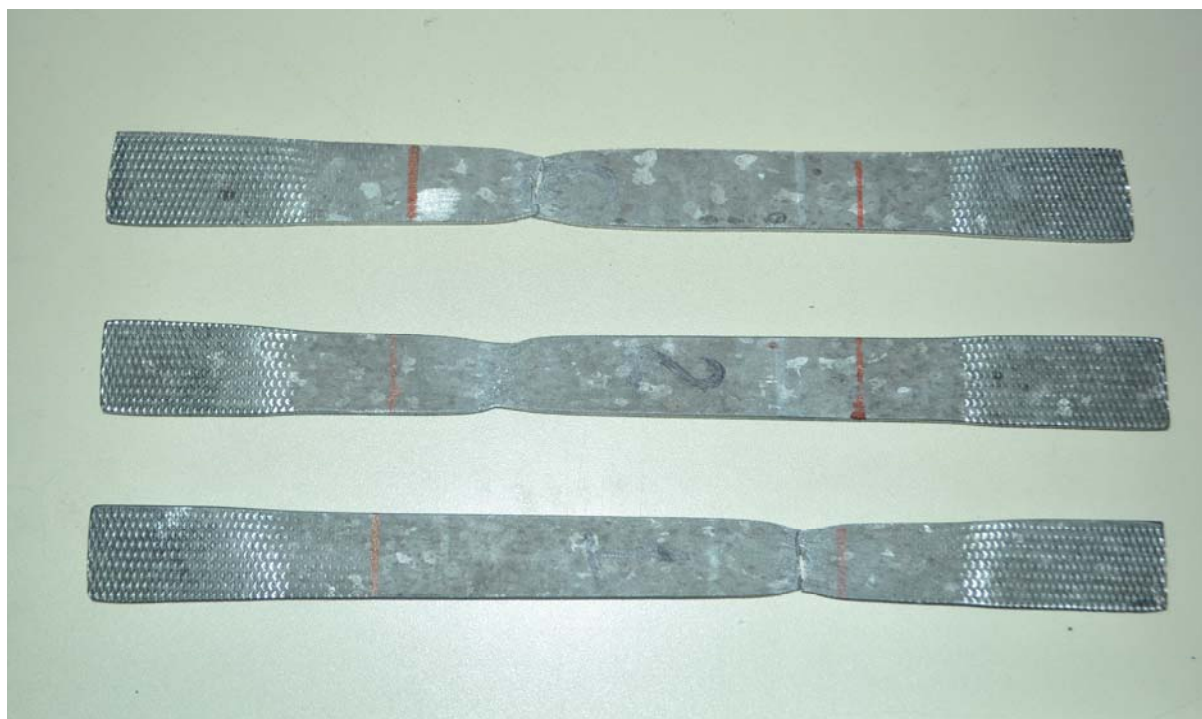
Слика 93. Испитните епрувети после истегнувањето до кинење
