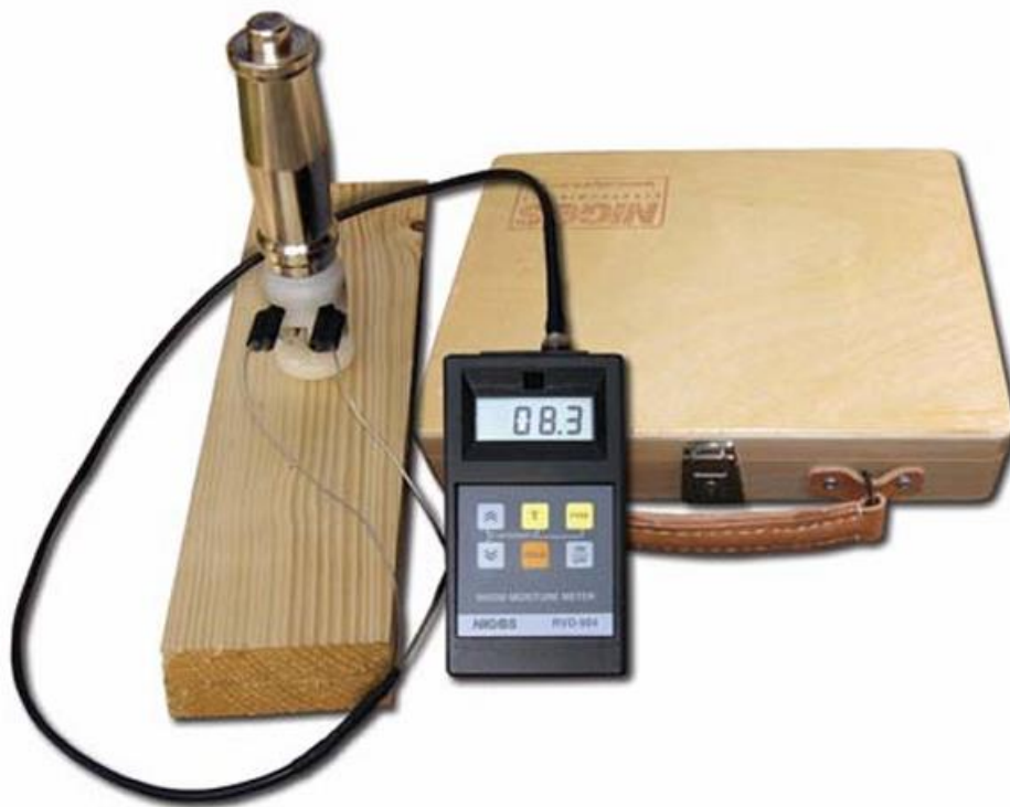
Слика 21. Електричен влагомер за мерење на влажност на дрвото (извор: www.nigos.rs )
