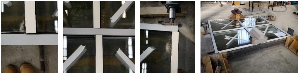
Слики 4.4.47 – 4.4.50: Деформации на профилите и врските кај моделот
