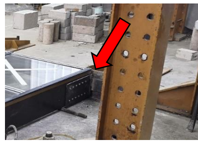
Слика 4.4.4: Укртување на рамката и Слика 4.4.5: Прицврстување со детал од 12 завртки
