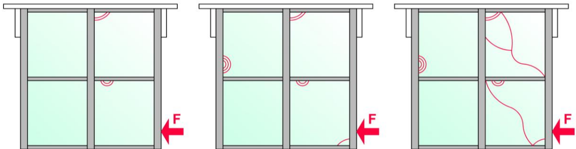
Слика 4.4.32: Постепено пукање на долните стакла при сила од 12kN
