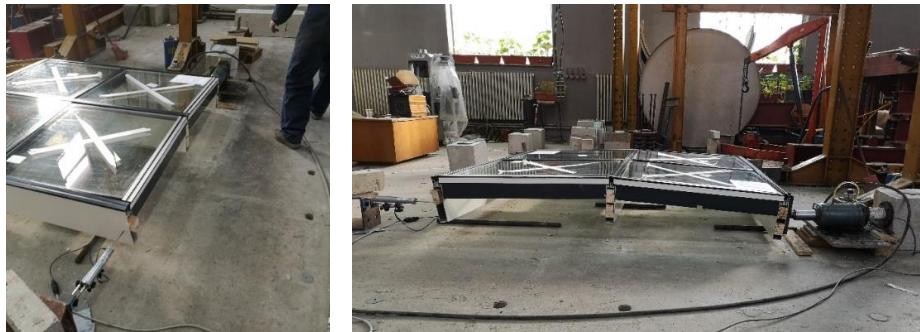
Слики 4.4.38 и 4.4.39: Бочно извивање при сила од 12 kN
