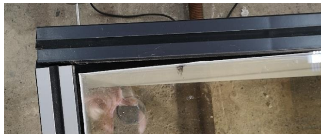
Слика 4.4.21: Деформации кај вториот модел при сила од 11kN
