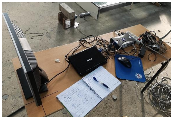
Слика 4.4.10: Опремена за добивање на податоци од мерење преку софтверски пакет НВМ Catman Easy
