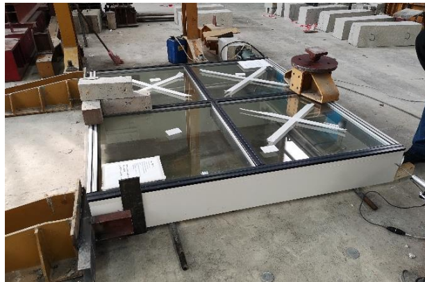
Слика 4.4.23: Поставување на товар врз моделот за да се спречи бочното извивање
