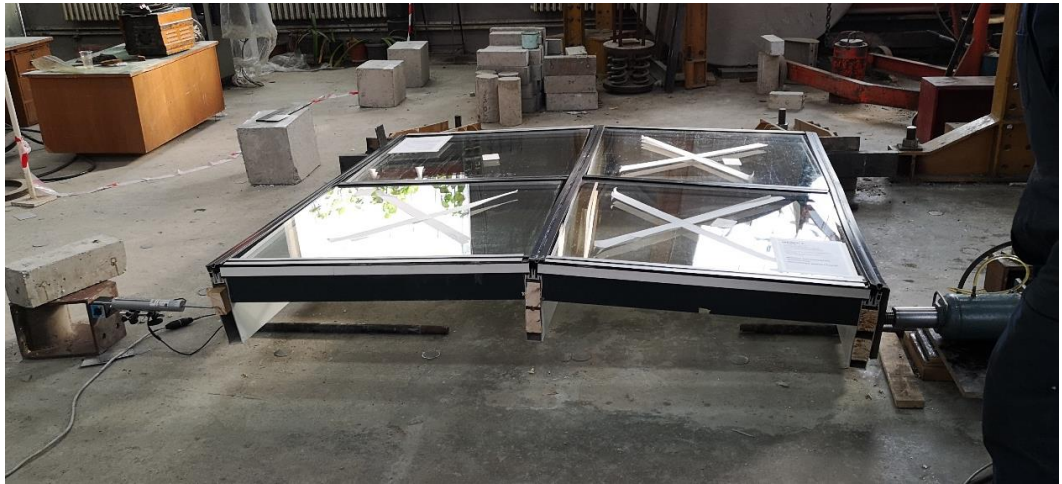
Слика 4.4.22: Бочно извивање на вториот модел
