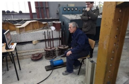
Слика 4.4.8 и 4.4.9: Уред поврзан со пресата за рачно зголемување на силата
