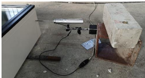
Слика 4.4.6: Електронски уклономер за мерење на поместувања
