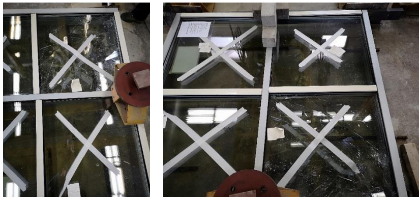
Слики 4.4.53 и 4.4.54: Состојба на третиот модел после испитување
