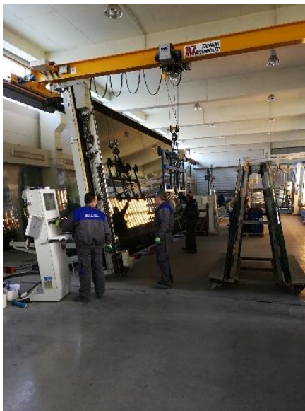
Слика 3.7 и 3.8: Кран за подигнување и машина за сечење на стаклата во фирмата „Интер Ал-Пин“ [приватни фотографии]
