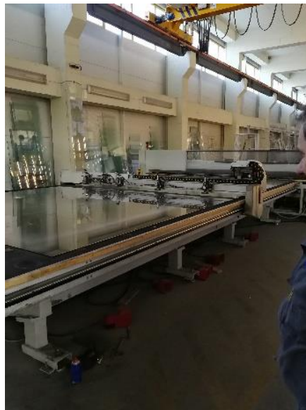
Слика 3.7 и 3.8: Кран за подигнување и машина за сечење на стаклата во фирмата „Интер Ал-Пин“ [приватни фотографии]
