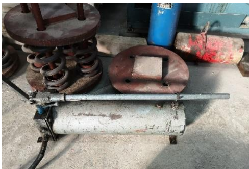
Слика 4.4.8 и 4.4.9: Уред поврзан со пресата за рачно зголемување на силата
