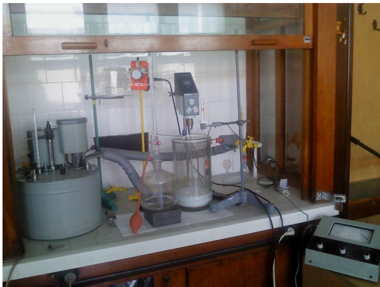
Слика 11. Апаратура за синтеза на слоестите двојни хидроксиди (LDH)
