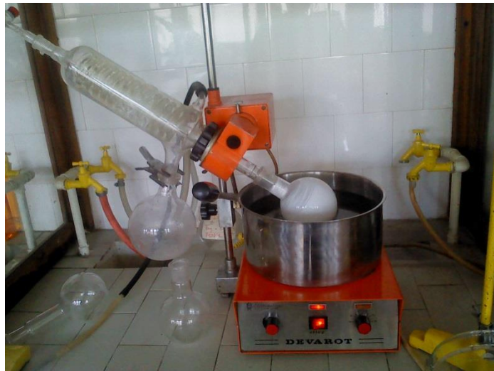
Слика 12. Апаратура за влажна импрегнација - ротационен вакуум испарувач
