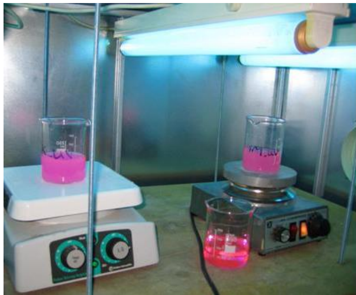
Слика 13. UV/VIS комора во која се одвиваат фотокаталитичките реакции
