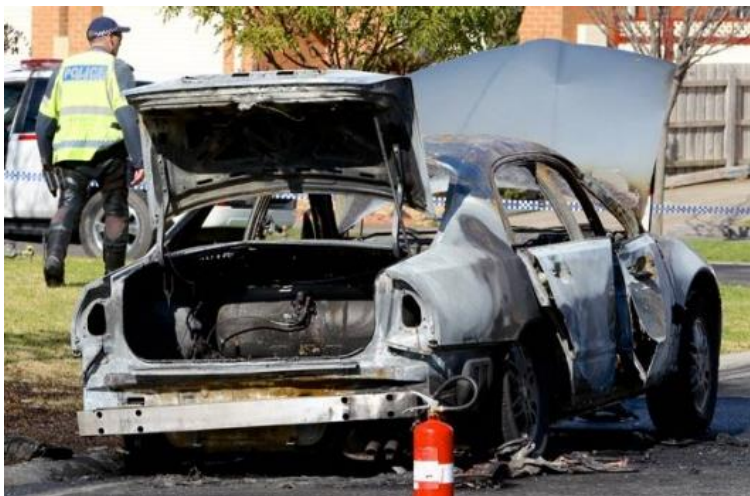
Слика 5. Изгорено возило Mitsubishi Magna поради истекување на ТНГ во возилото
