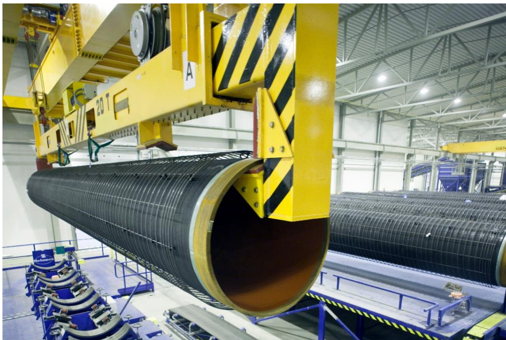
сл. бр. 5 Производство на цевки за гасоводот, преземено од: https://www.gazprom.com/preview/f/posts/04/069336/w1100_23-11-2016_nord_stream_4.jpg
