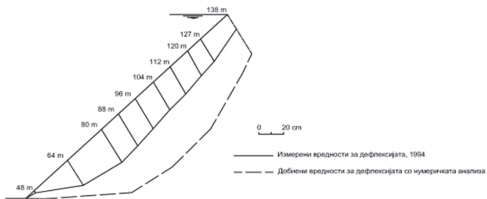
Слика 11. Деформации во бетонскиот екран на браната „Ксинго“, прикажани со две криви. Едната е добиена со мерни вредности од вистинските поместувања во екранот, веднаш по првото полнење на акумулацијата во 1994 година, а другата крива е добиена со нумеричката анализа на браната.
