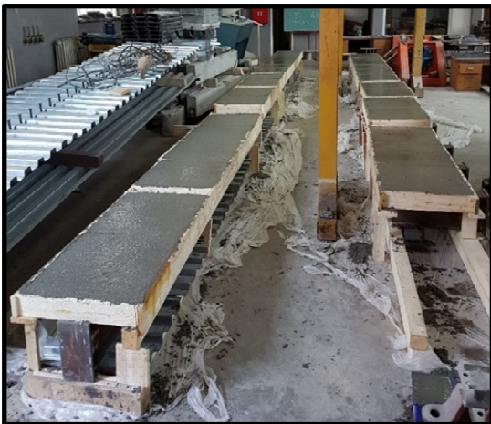
Сл. 8. Бетонирање на пробните тела
