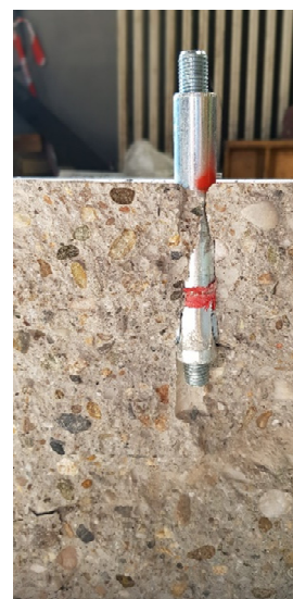
Сл. 8. Механички анкер по испитување и достигнат максимален товар
