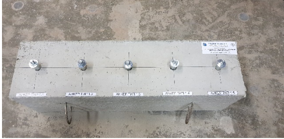
Сл. 3. Шема за вградување на механички анкери во анкер- блокови
