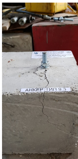
Сл. 7. Лом проследен со цепање на бетонот при максимално достигнат товар
