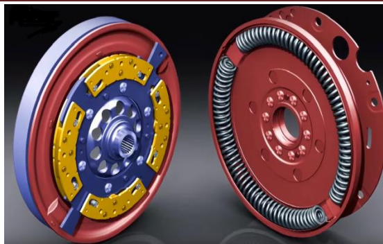
Фиг.4.Първична и вторична маса на двумасов маховик
