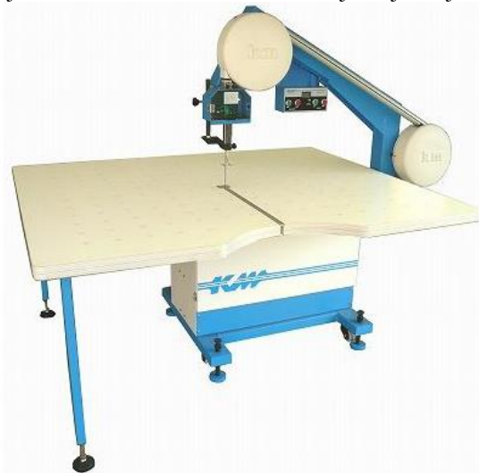
Slika 8. Prikaz uređaja za grubo krojenje (Rapid) KS-AU za krojenje svih vrsta tekstilnih materijala [12]
