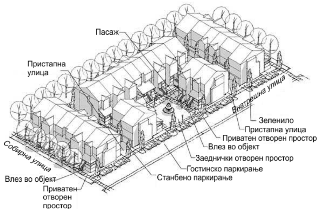
Сл. 6. Аксонометрија - урбанистички блок со куќи во низ и стандардно оформени парцели
