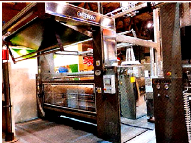
Sl. 5 Linija sistema za sanforizaciju firme Ferrarose
