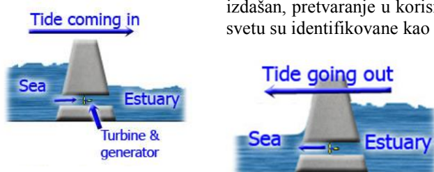
Slika 1. i 2. Skupljanje energije iz plime i oseke, grafički prikaz
