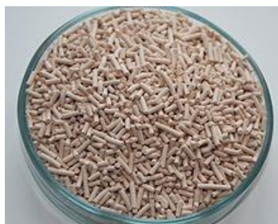
Сл.3 Структура на порест материјал –Зеолит 4А
