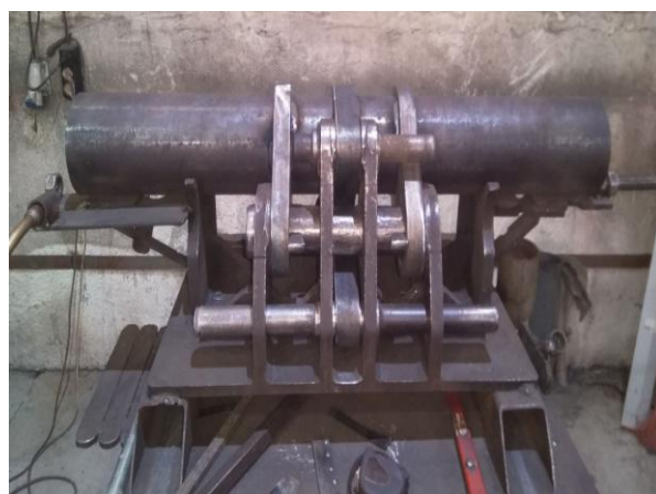
Фиг. 9. Приспособлението с установени детайли на дясна тръба за грайферна кофа 1000 mm.
