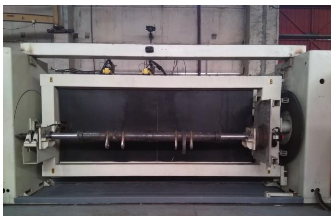
Фиг. 11. Комплект тръби за грайферна кофа 1000 mm, установени на заваръчен робот.
