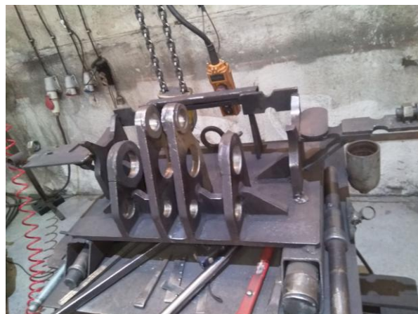
Фиг. 8. Приспособление за сглобяване на леви и десни тръби за грайферни кофи.
