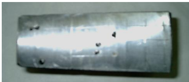
Рис. 2. Фрагменты поверхности модели слитка с газовыми пузырями
