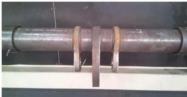
Фиг. 12. Дясна тръба за грайферна кофа 1000 mm след заваряване.
