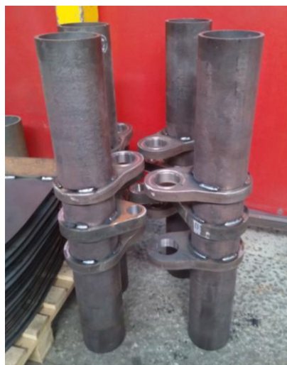
Фиг. 10. Леви и десни тръби за грайферна кофа 1000 mm, сглобени с приспособлението.
