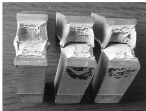
Slika 8. Izgled preloma epruveta iz uzorka kolektora koji je jedanput termički tretiran prema dijagramu termičke obrade, K-133-II.
