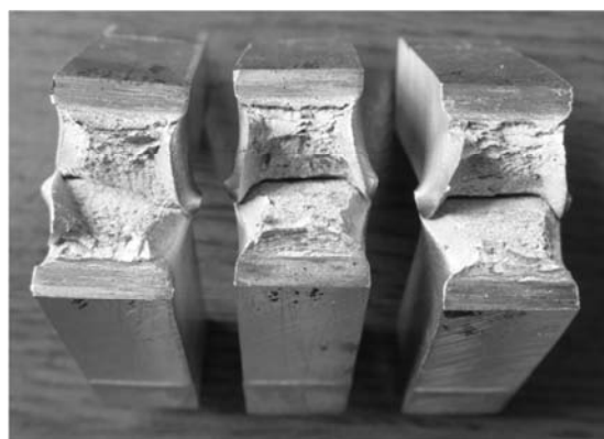
Slika 9. Izgled preloma epruveta iz uzorka kolektora koji je jedanput termički tretiran prema dijagramu termičke obrade, K-133-III.
