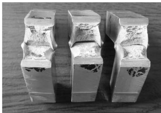
Slika 7. Izgled preloma epruveta iz uzorka kolektora koji je jedanput termički tretiran prema dijagramu termičke obrade, K-133-I.
