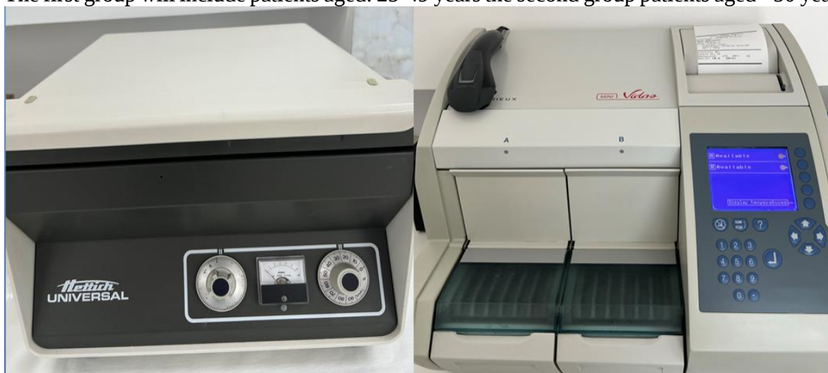
Figure 3: Hettich Universal 1200 centrifuge and Mini Vidas Biomerieux (Hettich Universal centrifuge and Mini Vidas-Albimedica laboratory, 2025)
