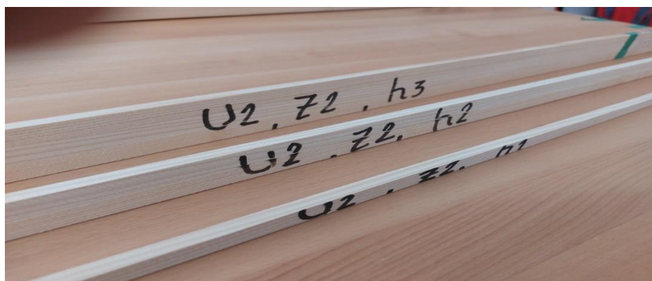
Слика 24. Проби од ЧАМ добиени при брзина на поместување U_2=16 \text{ mm} \cdot \text{min}^{-1} , број на заби од кружната пила Z_2=60 , за височини на режење h_1=15\text{mm} , h_2=30\text{mm} и h_3=45\text{mm}
