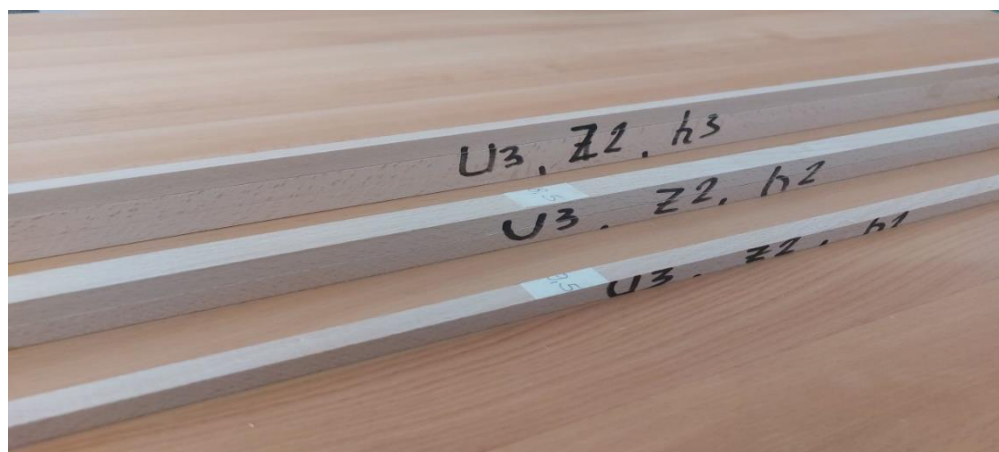
Слика 18. Проби од БУКА добиени при брзина на поместување U_3=20 \text{ mm min}^{-1} , број на заби од кружната пила Z_2=60 , за височини на режење h_1=15\text{mm} , h_2=30\text{mm} и h_3=45\text{mm}
