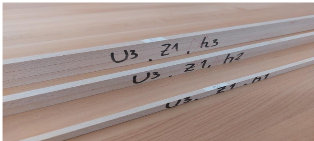
Слика 17. Проби од БУКА добиени при брзина на поместување U_3=20 \text{ mm min}^{-1} , број на заби од кружната пила Z_1=40 , за височини на режење h_1=15\text{mm} , h_2=30\text{mm} и h_3=45\text{mm}
