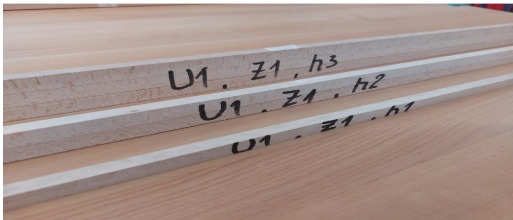
Слика 11. Проби од БУКА добиени при брзина на поместување U_1=12 \text{ mm} \cdot \text{min}^{-1} , број на заби од кружната пила Z_1=40 , за височини на режење h_1=15\text{mm} , h_2=30\text{mm} и h_3=45\text{mm}
