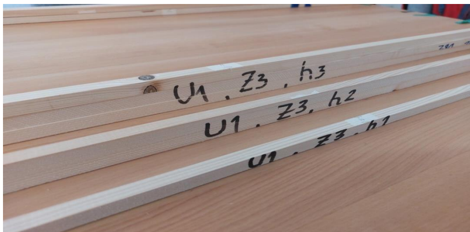
Слика 22. Проби од ЧАМ добиени при брзина на поместување U_1=12 \text{ mm} \cdot \text{min}^{-1} , број на заби од кружната пила Z_3=80 , за височини на режење h_1=15\text{mm} , h_2=30\text{mm} и h_3=45\text{mm}
