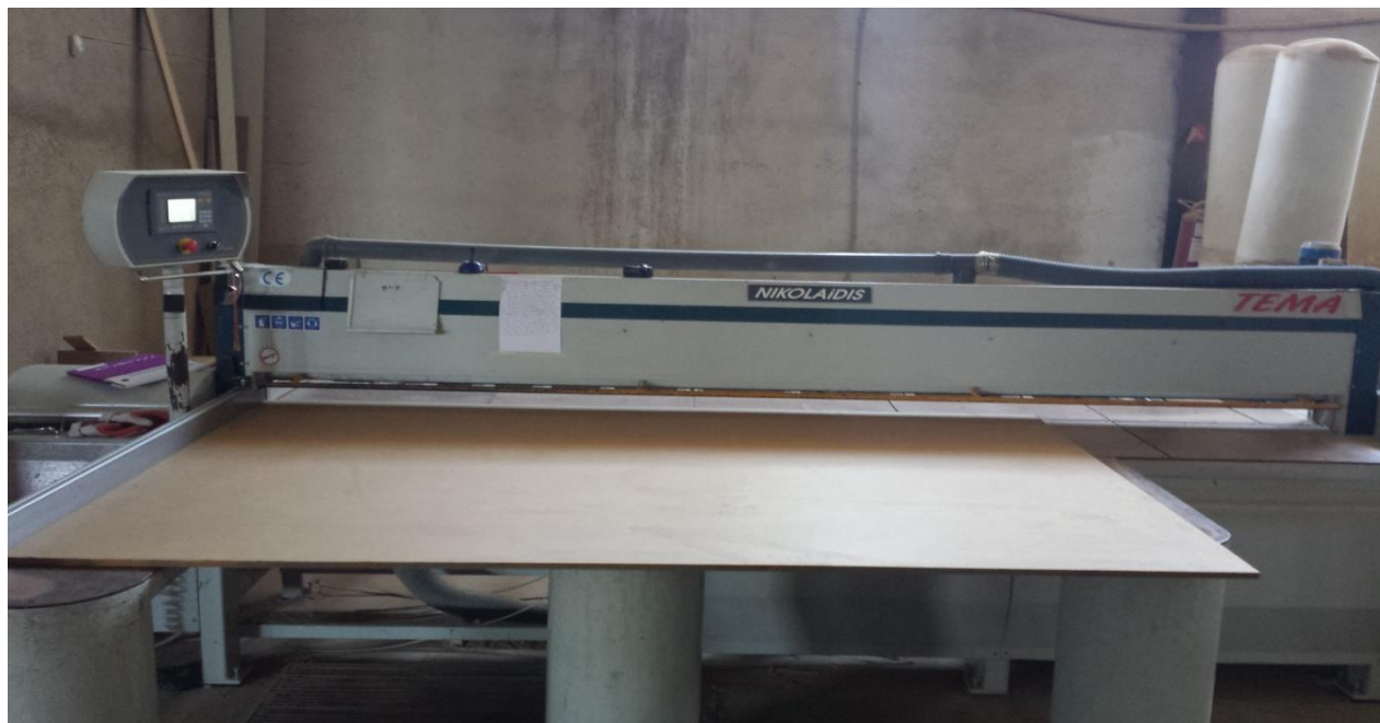
Слика 1. Изглед на основната машина-форматна кружна пила од грчко потекло: NIKOLAIDIS TEMA 3800
