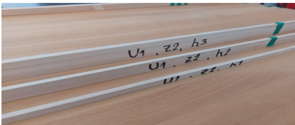
Слика 12. Проби од БУКА добиени при брзина на поместување U_1=12 \text{ mm} \cdot \text{min}^{-1} , број на заби од кружната пила Z_2=60 , за височини на режење h_1=15\text{mm} , h_2=30\text{mm} и h_3=45\text{mm}
