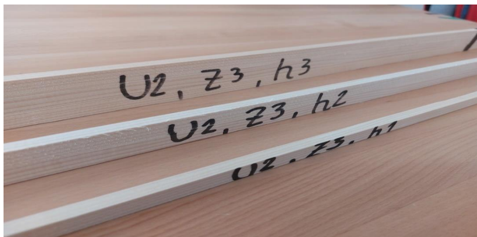
Слика 25. Проби од ЧАМ добиени при брзина на поместување U_2=16 \text{ mm} \cdot \text{min}^{-1} , број на заби од кружната пила Z_3=80 , за височини на режење h_1=15\text{mm} , h_2=30\text{mm} и h_3=45\text{mm}
