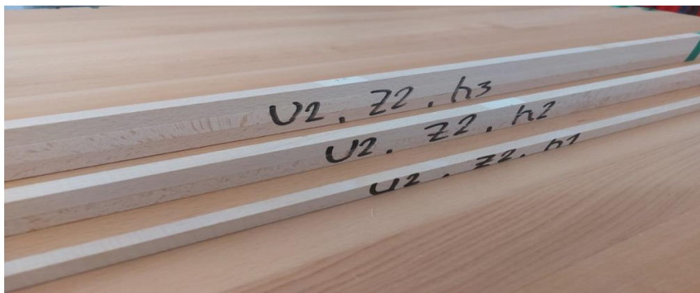
Слика 15. Проби од БУКА добиени при брзина на поместување U_2=16 \text{ mm} \cdot \text{min}^{-1} , број на заби од кружната пила Z_2=60 , за височини на режење h_1=15\text{mm} , h_2=30\text{mm} и h_3=45\text{mm}
