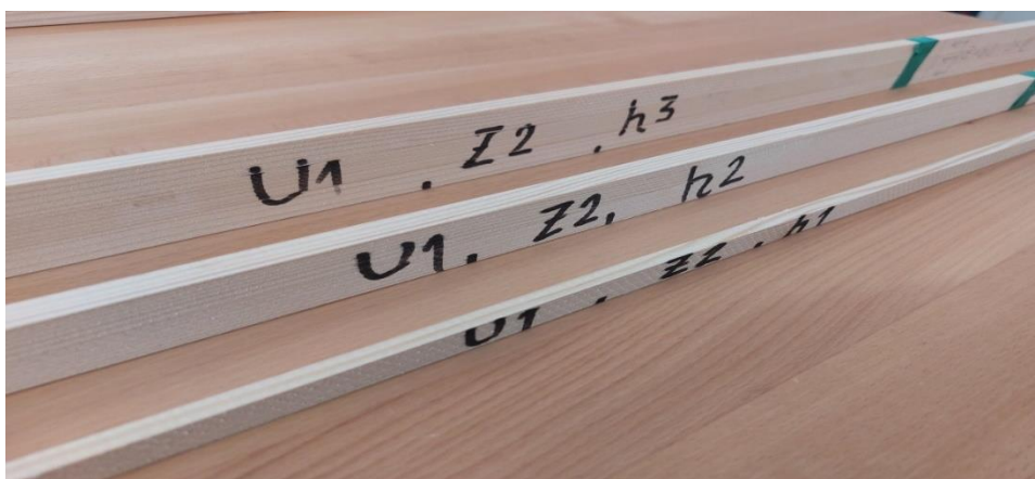
Слика 21. Проби од ЧАМ добиени при брзина на поместување U_1=12 \text{ mm} \cdot \text{min}^{-1} , број на заби од кружната пила Z_2=60 , за височини на режење h_1=15\text{mm} , h_2=30\text{mm} и h_3=45\text{mm}
