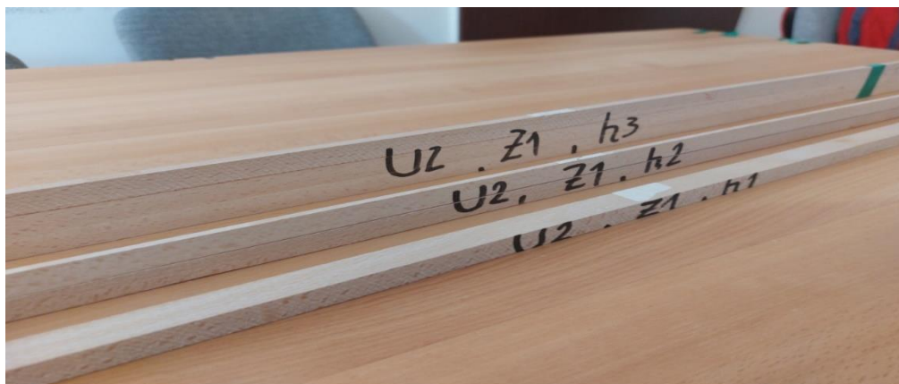
Слика 14. Проби од БУКА добиени при брзина на поместување U_2=16 \text{ mm} \cdot \text{min}^{-1} , број на заби од кружната пила Z_1=40 , за височини на режење h_1=15\text{mm} , h_2=30\text{mm} и h_3=45\text{mm}
