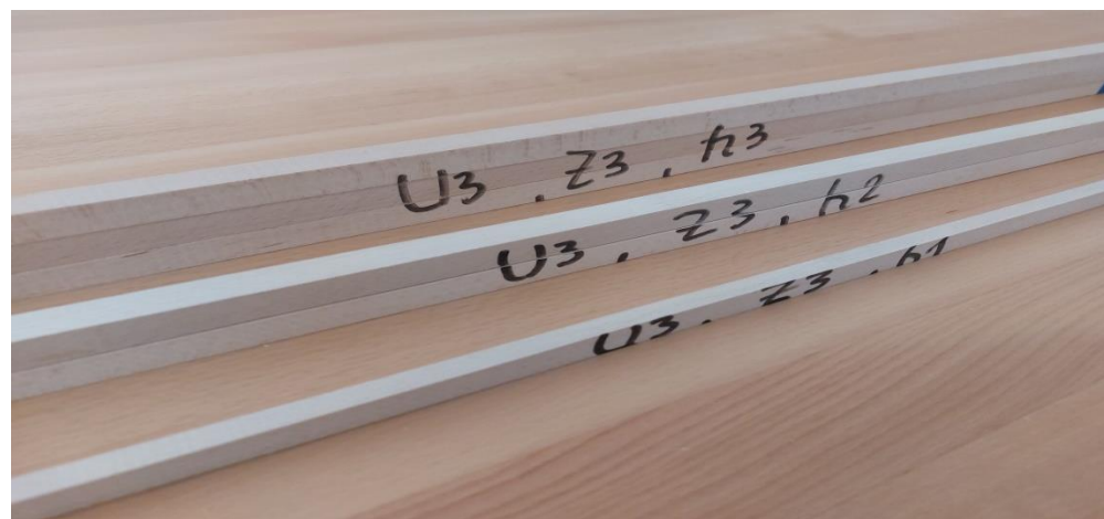
Слика 19. Проби од БУКА добиени при брзина на поместување U_3=20 \text{ mm min}^{-1} , број на заби од кружната пила Z_3=80 , за височини на режење h_1=15\text{mm} , h_2=30\text{mm} и h_3=45\text{mm}
