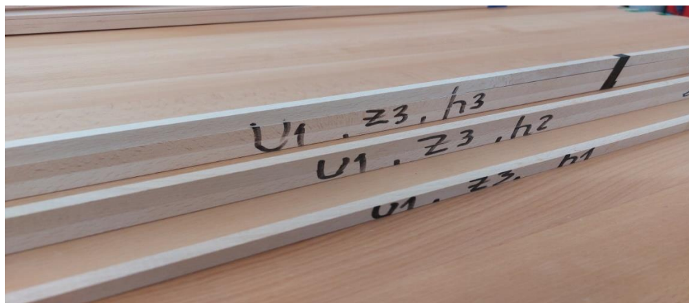
Слика 13. Проби од БУКА добиени при брзина на поместување U_1=12 \text{ mm} \cdot \text{min}^{-1} , број на заби од кружната пила Z_3=80 , за височини на режење h_1=15\text{mm} , h_2=30\text{mm} и h_3=45\text{mm}
