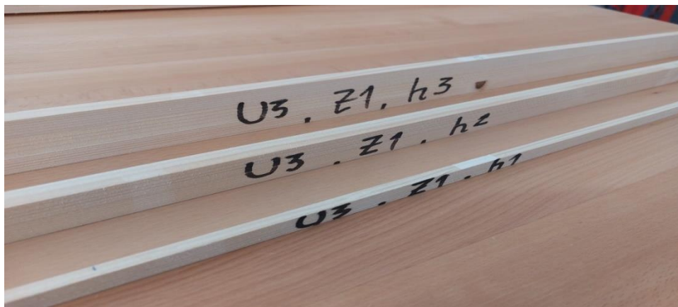
Слика 26. Проби од ЧАМ добиени при брзина на поместување U_3=20 \text{ mm} \cdot \text{min}^{-1} , број на заби од кружната пила Z_1=40 , за височини на режење h_1=15\text{mm} , h_2=30\text{mm} и h_3=45\text{mm}
