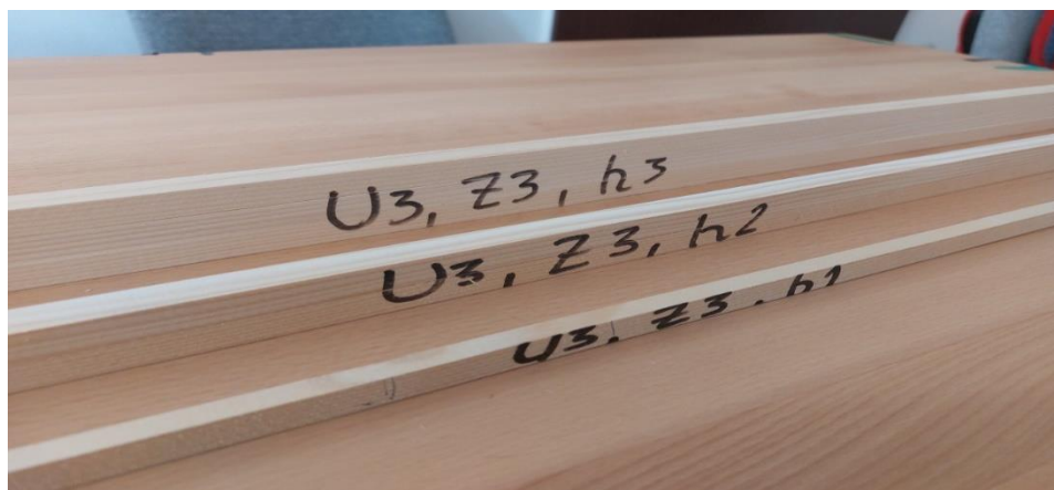
Слика 28. Проби од ЧАМ добиени при брзина на поместување U_3=20 \text{ mm} \cdot \text{min}^{-1} , број на заби од кружната пила Z_3=80 , за височини на режење h_1=15\text{mm} , h_2=30\text{mm} и h_3=45\text{mm}
