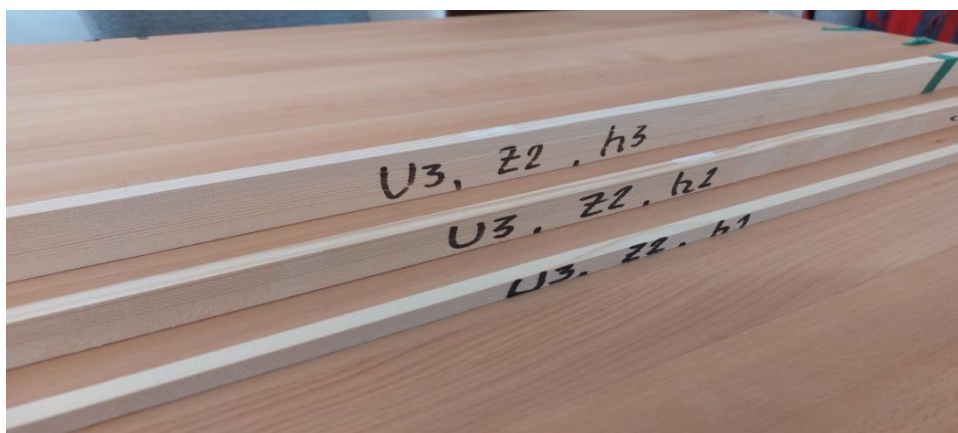
Слика 27. Проби од ЧАМ добиени при брзина на поместување U_3=20 \text{ mm} \cdot \text{min}^{-1} , број на заби од кружната пила Z_2=60 , за височини на режење h_1=15\text{mm} , h_2=30\text{mm} и h_3=45\text{mm}
