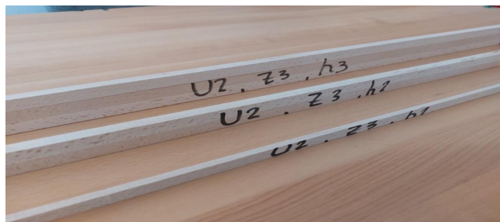
Слика 16. Проби од БУКА добиени при брзина на поместување U_2=16 \text{ mm} \cdot \text{min}^{-1} , број на заби од кружната пила Z_3=80 , за височини на режење h_1=15\text{mm} , h_2=30\text{mm} и h_3=45\text{mm}
