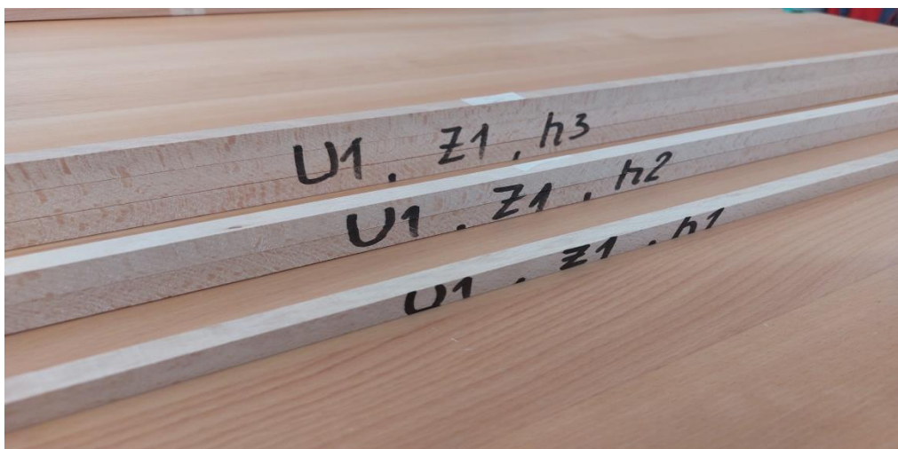
Слика 8. Проби од БУКА добиени при брзина на поместување U_1=12 \text{ mm} \cdot \text{min}^{-1} , број на заби од кружната пила Z_1=40 , за височини на режење h_1=15\text{mm} , h_2=30\text{mm} и h_3=45\text{mm}
