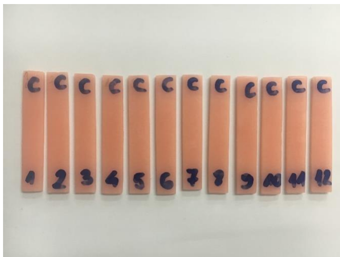
Слика 6: Група од 12 акрилатни примероци, припремена за испитување отпорност на свиткување
