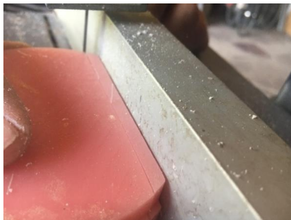
Слика 4: Припрема на акрилатен примерок од CAD/CAM-група: а) индустриска тракаста тестера и б) сечење CAD/CAM акрилатен блок
