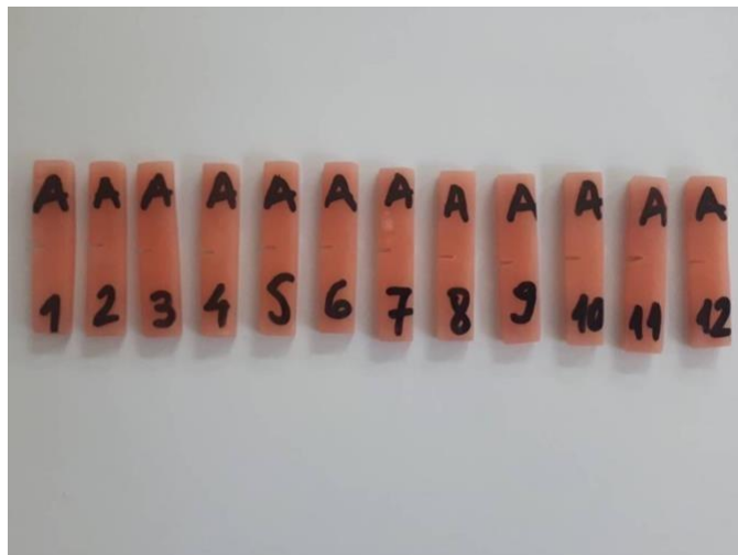
Слика 8: Група од 12 акрилатни примероци, припремена за испитување отпорност на кршење
