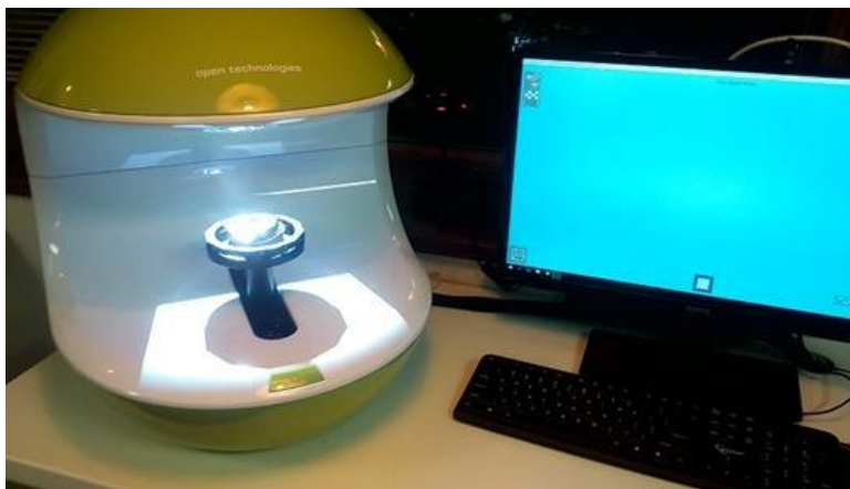
Слика 3: Скенирање модел со 3-Д оптички лабораториски скенер
