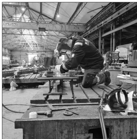
Slika 6. Navarivanje glave šine
