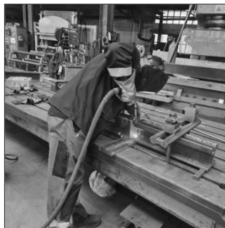
Slika 4. Zavarivanje šape šine za blok
