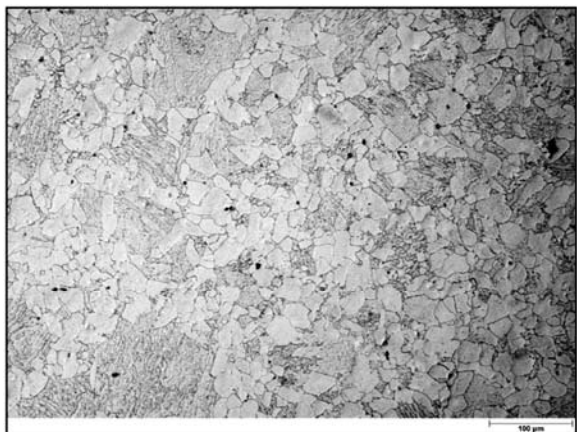
Slika 6. Referentne slike za materijal 10CrMo9-10 klasa ocjene 2a, prema standardu VGB-S 517 [5]
