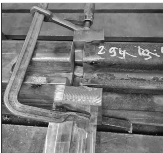
Slika 5. Zavareni vrat šine za blok
