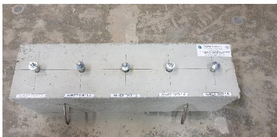
Сл. 2. Шема за вградување на механички анкери во анкер- блокови
