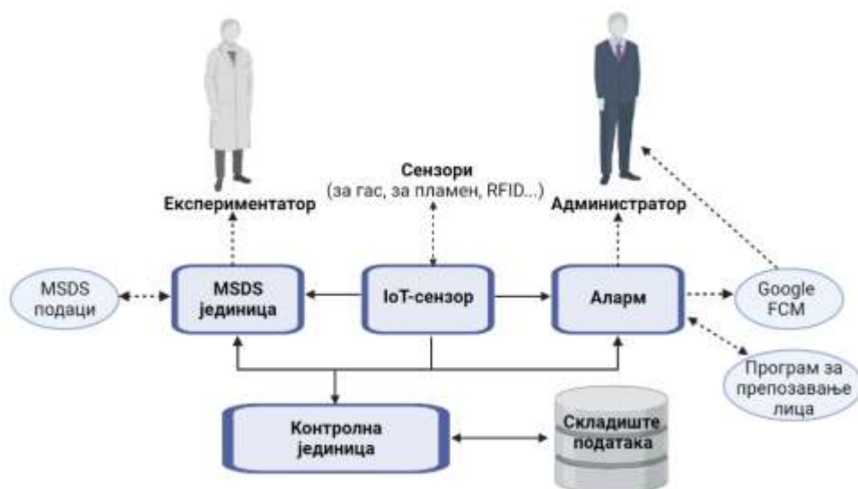
Слика 2. Систем за управљање безбедношћу у хемијској лабораторији заснован на паметним технологијама (преузето од: [9])
