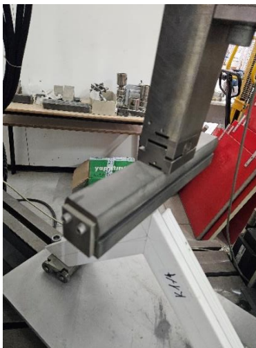
Слика 13 Нанесување на притисок со брзина 50 \pm 5 \text{ mm/min}
