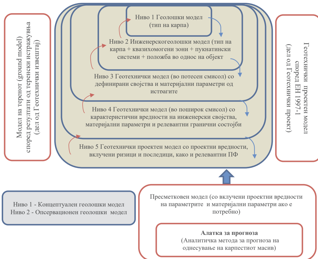
Сл. 1 Видови и хиерархија на модели во втората генерација на Еврокод 7 (прилагодено и делумно дополнето, според [1])
