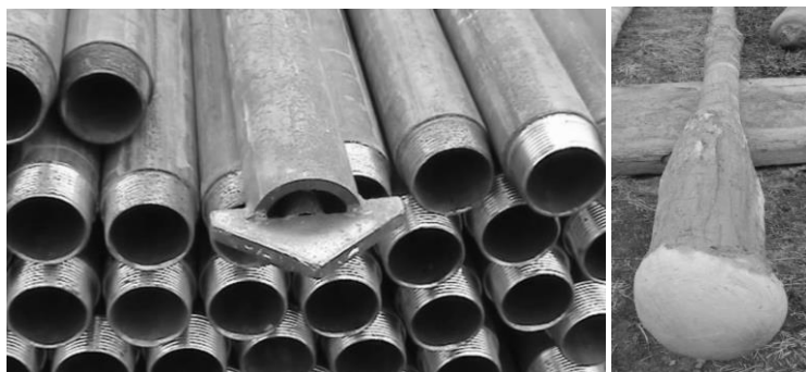
Слика 1. Приказ челичне цеви за бушење са сврдлом и инјекционог микро-шипа, тип HekPile Figure 1. Preview of drilling steel tube with crown and injection micro-pile type HekPile
