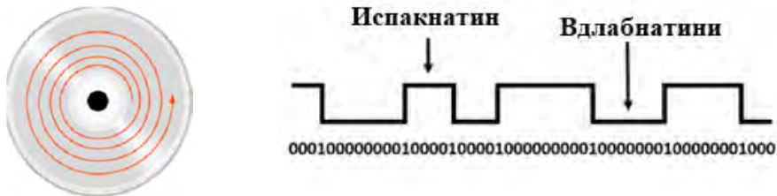
СЛИКА 1. Лево: Спирална форма на запишување; Десно: Бинарна форма на претставување на запишаните информации на CD и DVD диск
