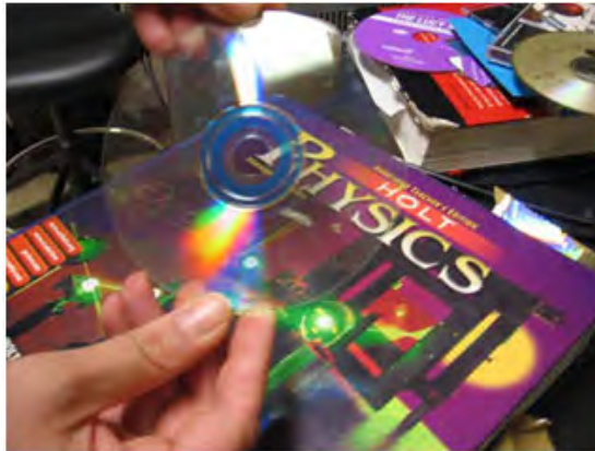
СЛИКА 5. Подготвен DVD диск за употреба како трансмисиона дифракциона решетка
