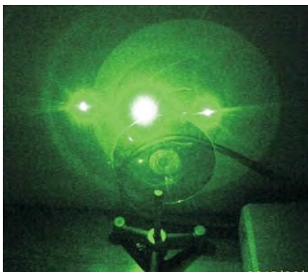
СЛИКА 7. Реален приказ и видливи резултати од експерименталната поставка во која DVD диск е употребен како трансмисиона дифракциона решетка
