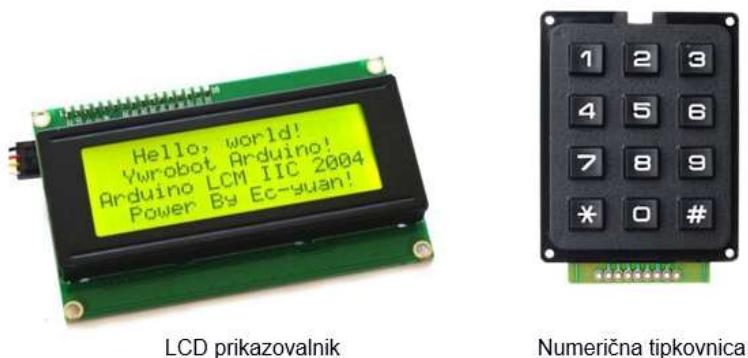
Slika 7: LCD prikazovalnik in numerična tipkovnica Vir: https://www.arduino.cc/
