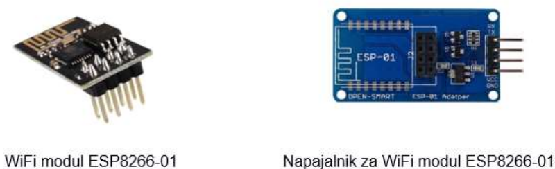
Slika 8: WiFi modul in napajalnik za modul Vir: https://www.arduino.cc/
