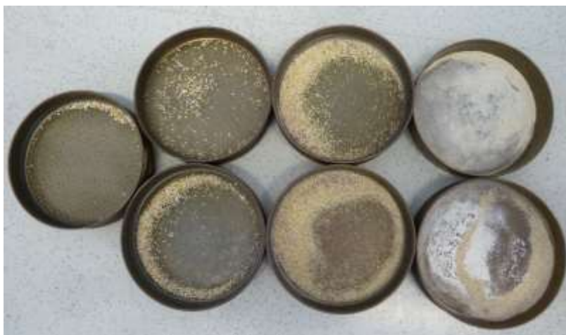
Slika 1: Sita in skodela klasičnega sejalnega testa (Rezar, 2020)
