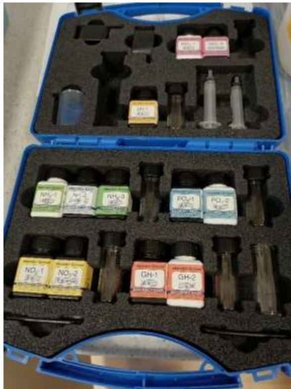
Slika 29: Kovček za kemijsko analizo vode Vir: Lasten
