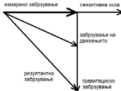
Слика 2. Одредување на резултантното забрзување кај акцелерометарот
