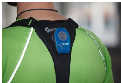
Слика 8. 3Д-инерционен сензор поставен на грбот за да се утврди балансот и степенот на нишање на телото
