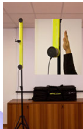
Слика 6. Вертикално поставена оптичка подлога за мерење на дофатната висина
