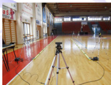
Слика 4. Сериски поврзани оптички подлоги синхронизирани со систем на фотокели
